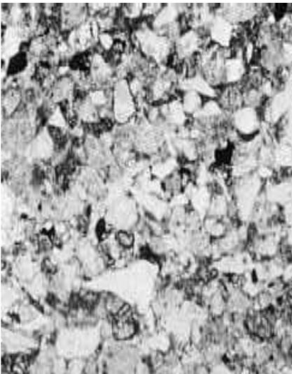
**Wacke feldespático** caracterizado por la presencia de granos de cuarzo, feldespatos y micas. Su textura muestra clastos angulosos moderadamente seleccionados y una gran cantidad de matriz arcillosa. Fotografía de un corte delgado observado mediante microscopio petrográfico con polarizadores paralelos (González Riga, en estudio).
