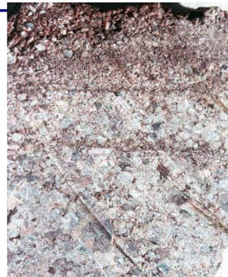
**Figura 10.** Estratificación gradada en una roca clástica
