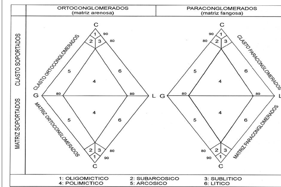
**Clasificación de las psefitas (conglomerados) basada en la fábrica, tipo de matriz y composición de los clastos (Limarino et al., 1996). Referencias: C = cuarzo + chert + cuarcitas; G = granitos + gneises + delfespatos; L = otros fragmentos líticos.**
