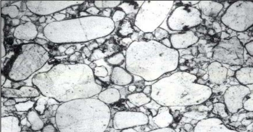
**Arenita arcosa** caracterizada por el dominio de clastos de cuarzo y cementos silíceo y ferruginoso. Fotografía de un corte delgado observado mediante microscopio petrográfico con polarizadores paralelos (Scasso y Limarino, 1997).
