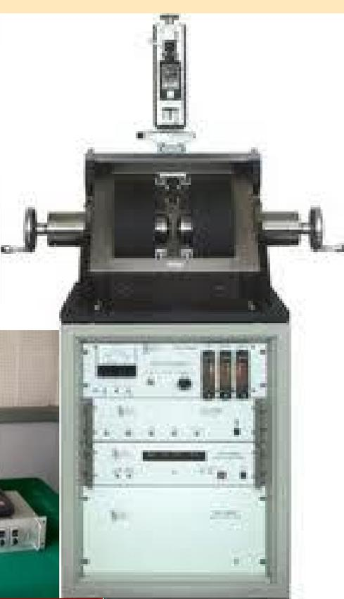
Un magnetómetro, es un dispositivo que mide la intensidad y la dirección del vector magnético de la muestra.
