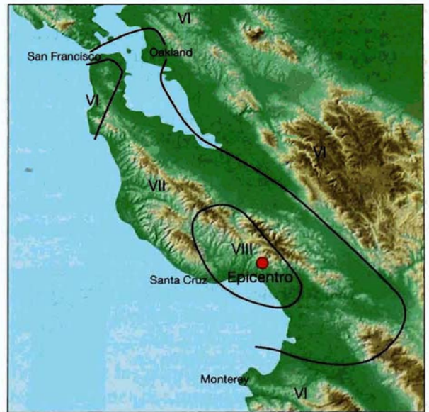
▲ Figura 11.13 Zonas de destrucción asociadas con el terremoto de Loma Prieta, California, ocurrido en 1989 utilizando la escala de intensidad de Mercalli modificada. Las cifras romanas muestran las categorías de intensidad. La zona de máxima intensidad corresponde aproximadamente al epicentro. Se experimentaron intensidades incluso más elevadas en algunos puntos de San Francisco y Oakland, donde las condiciones locales amplificaron las ondas sísmicas. (Datos de Plafker y Galloway.)
