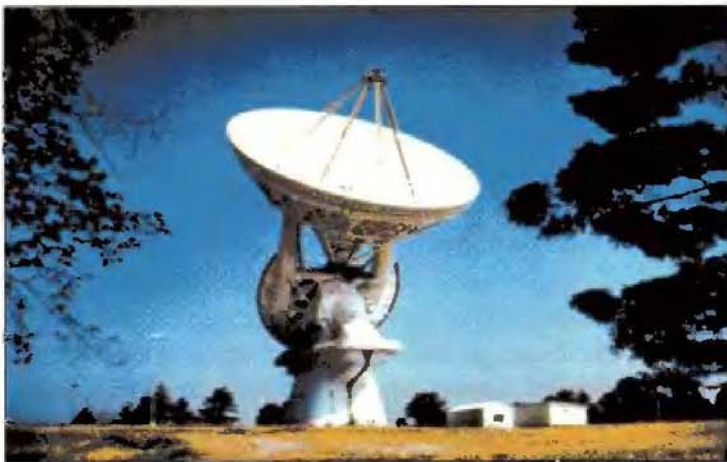
▲ Figura 2.27 Radiotelescopios como éste de Green Bank, West Virginia, se utilizan para determinar con precisión la distancia entre dos puntos alejados. Los datos recogidos por mediciones repetidas han detectado movimientos relativos de las placas de 1 a 15 centímetros al año entre distintos puntos de todo el mundo (cortesía de National Radio Astronomy Observatory).
