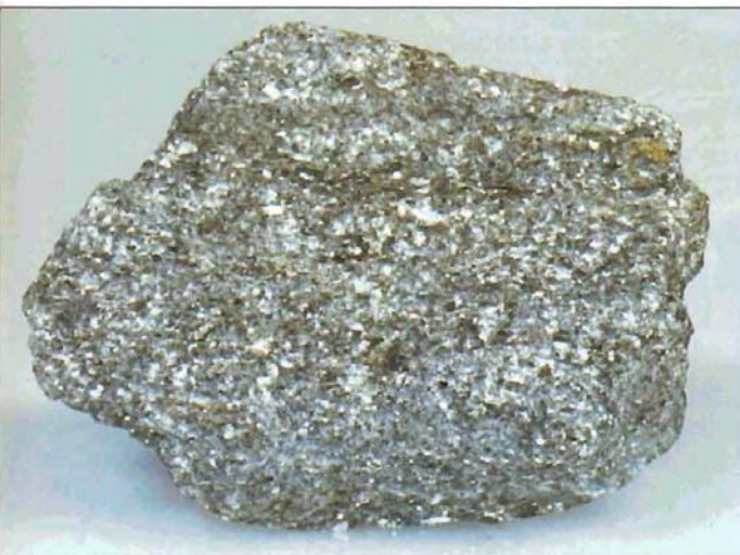
▲ Figura 8.12 Micasquistu. Esta muestra de esquistu está compuesta principalmente de moscovita y biotita. (Foto de E. J. Tarbuck.)
