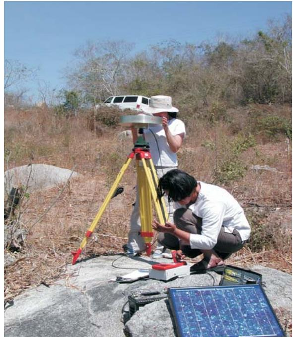
**Figura 2.6.** Equipo GPS utilizado en las estaciones temporales.
