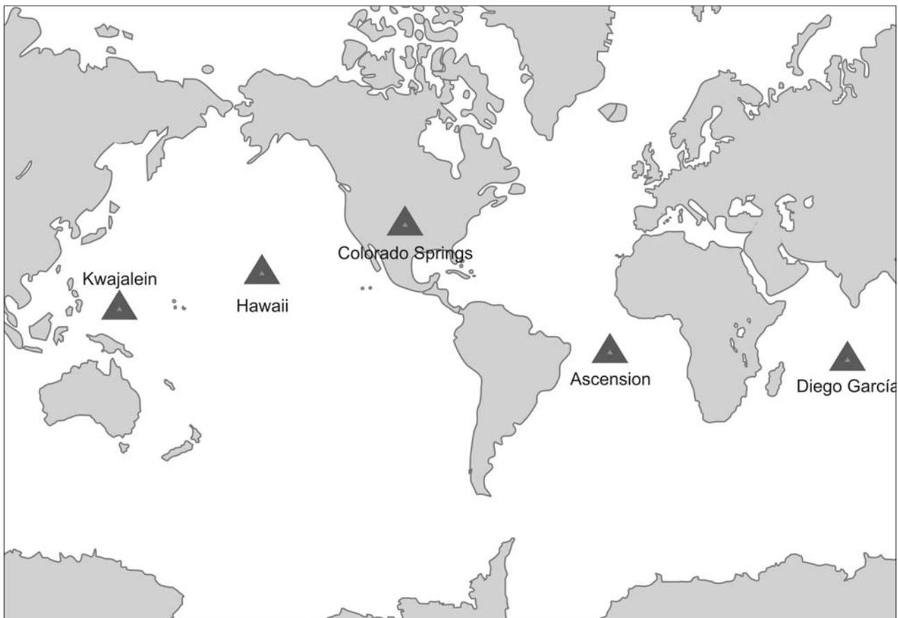
**Figura 2.1.** Localización de las estaciones del segmento de control.
