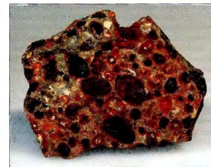
▲ Figura 21.20 La bauxita es la mena de aluminio y se forma como consecuencia de procesos de meteorización bajo condiciones tropicales. Su color oscila entre el rojo o el marrón y el casi blanco. (Foto de E. J. Tarbuck.)
