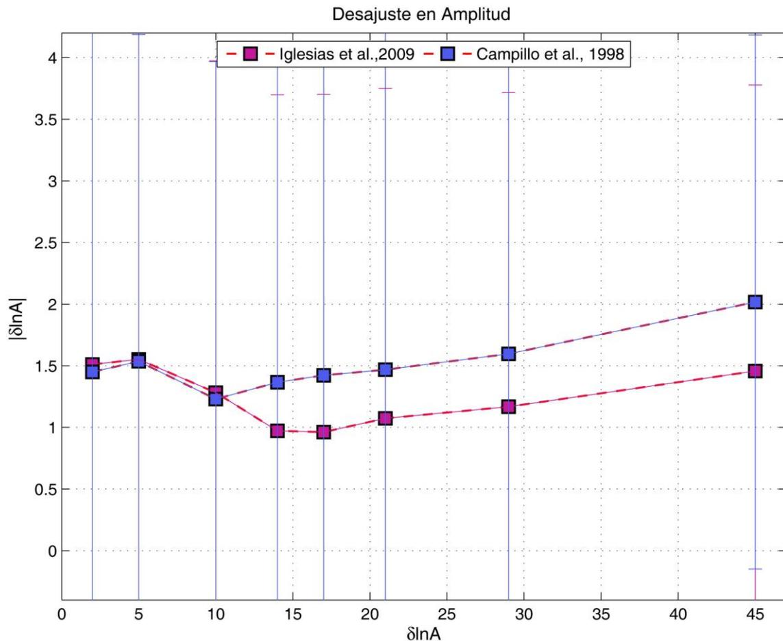
Figura 5.8 Desajuste promedio en amplitud (valor absoluto) a lo largo del arreglo MASE por período para el evento 1.EVE050814 en los modelos de Iglesias et al., 2010 (morado) y Campillo et al., 1996 (azul).
