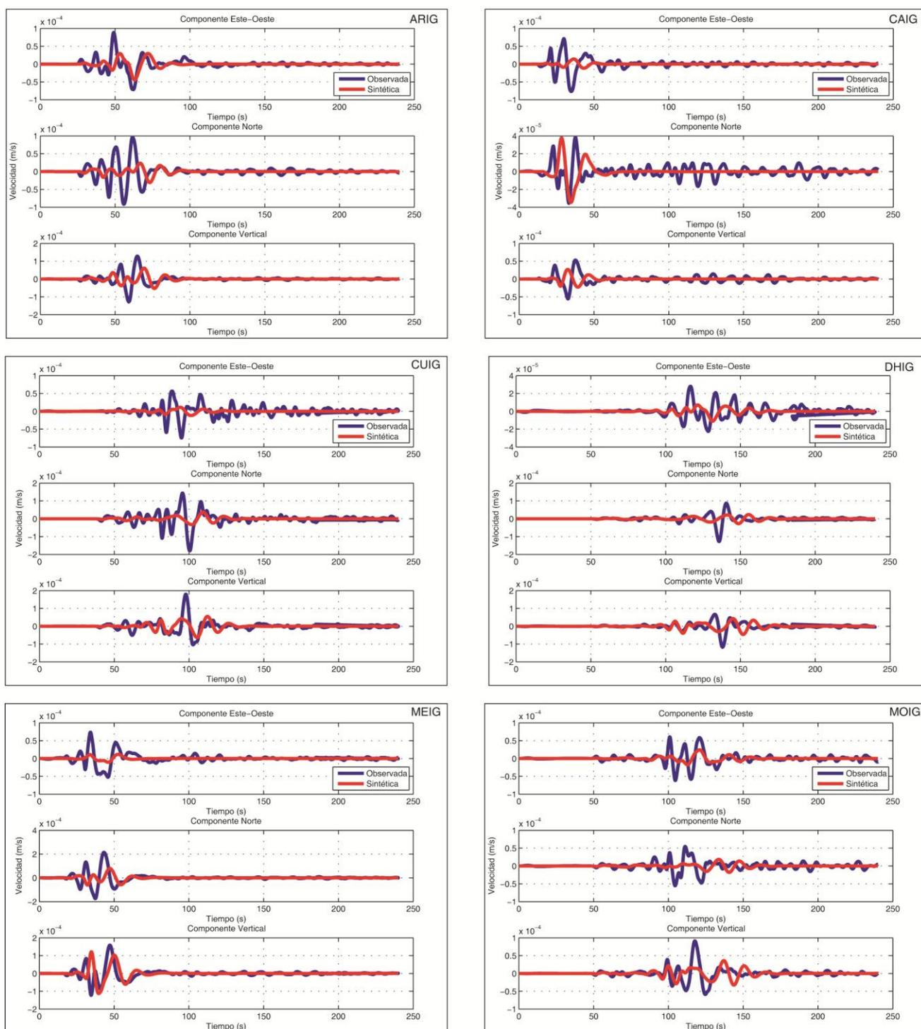
Figura 4 A Comparaciones de sismogramas Observados y Sintéticos para el sismo del 27 de Abril del 2009, Mw 5.8, registrado por 11 estaciones del SSN dentro de nuestra área de estudio (cuadro rojo) empleando el modelo cortical PREM (1982). Se presentan las 3 componentes (Este, Norte, Vertical), la línea azul representa los sismogramas observados y la roja los sintéticos, ambos filtrados con un filtro pasabajos a 10 s (0.1 Hz). Esta es la sección A con 6 estaciones.
