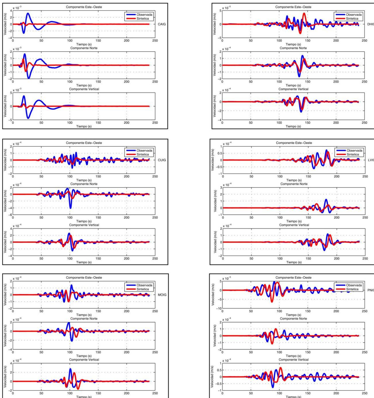
Figura 12 A Comparaciones de sismogramas Observados y Sintéticos para el sismo de Atocay Mw 5.9 del 13 de Abril de 2007, registrado por 8 estaciones del SSN dentro de nuestra área de estudio (cuadro rojo) empleando el modelo cortical Campillo et al., 1996. Se presentan las 3 componentes (Este, Norte, Vertical), la línea azul representa los sismogramas observados y la roja los sintéticos, ambos filtrados con un filtro pasabajos a 10 s (0.1 Hz). Esta es la sección A con 6 estaciones.
