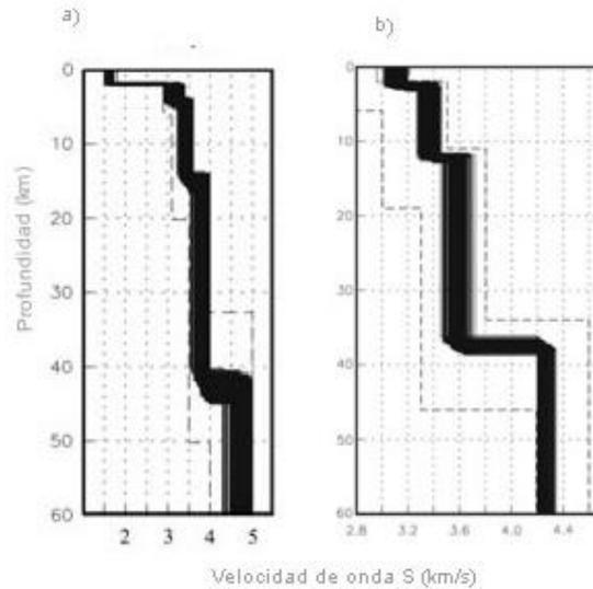
Figura 2.8 a) Modelo cortical en la estación CUIG (valle de México) con una capa de baja velocidad  $\sim 2$  km asociada a la FVTM y una discontinuidad de Conrad bien definida alrededor de los 15 km de profundidad. Un manto superior con una velocidad de ondas S y coeficiente de Poisson variable. b) Modelo de 4 capas planas por debajo de la estación ZAIG, en la Mesa Central (tomado y modificado de Cruz-Atienza et al., 2010).
