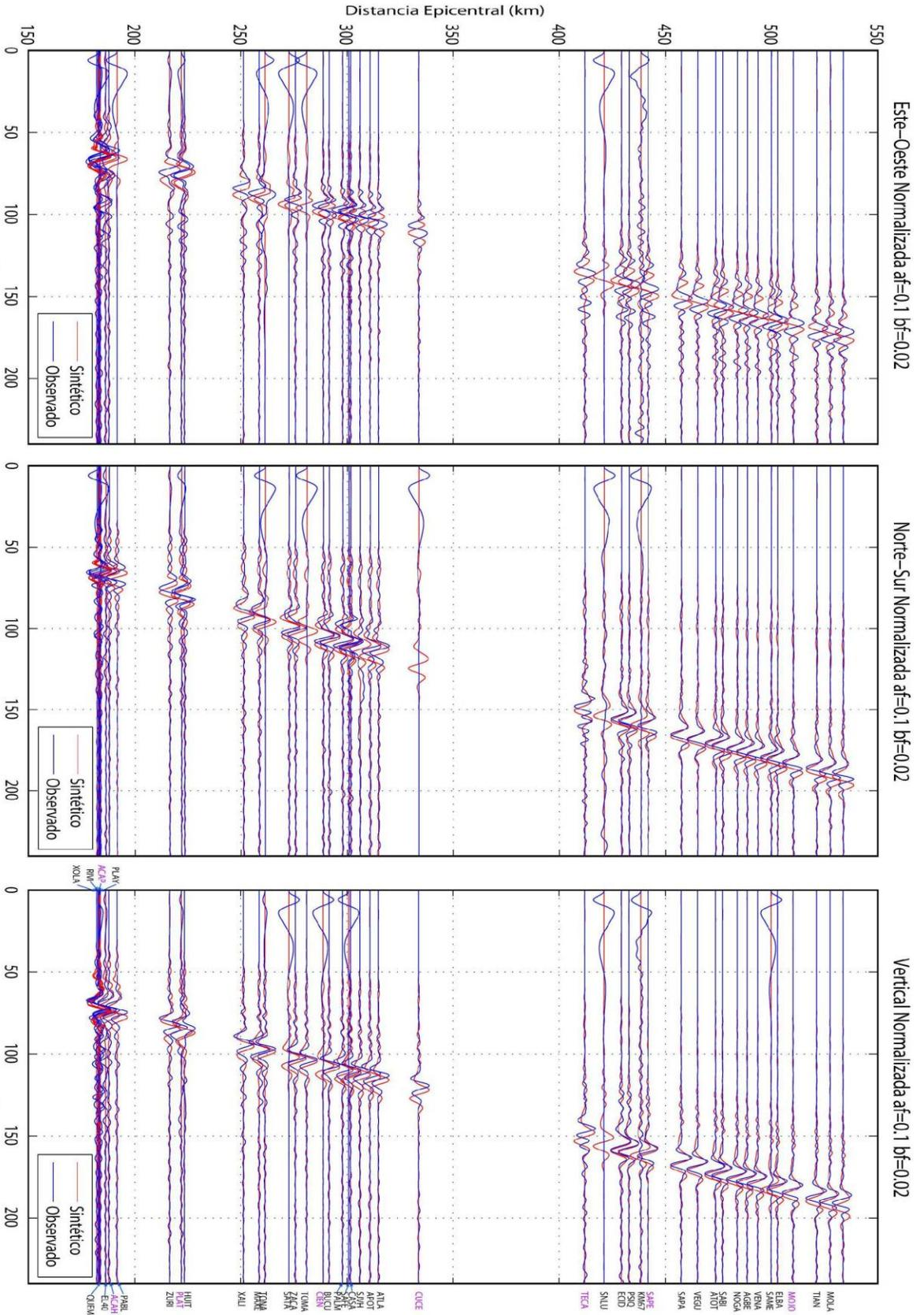
Figura 4.18 Comparaciones de sismogramas Observados y Sintéticos para el sismo del 14 de agosto del 2005 Mw 5.4, empleando el modelo cortical Iglesias et al., 2010 a lo largo de 44 estaciones del arreglo MASE. Se presentan las 3 componentes (Este, Norte, Vertical) los sismogramas están ordenados por distancia epicentral a partir de la costa (Acapulco), la línea azul representa los sismogramas observados y la roja los sintéticos, ambos filtrados con un filtro pasabajas a 10 s (0.1 Hz).
