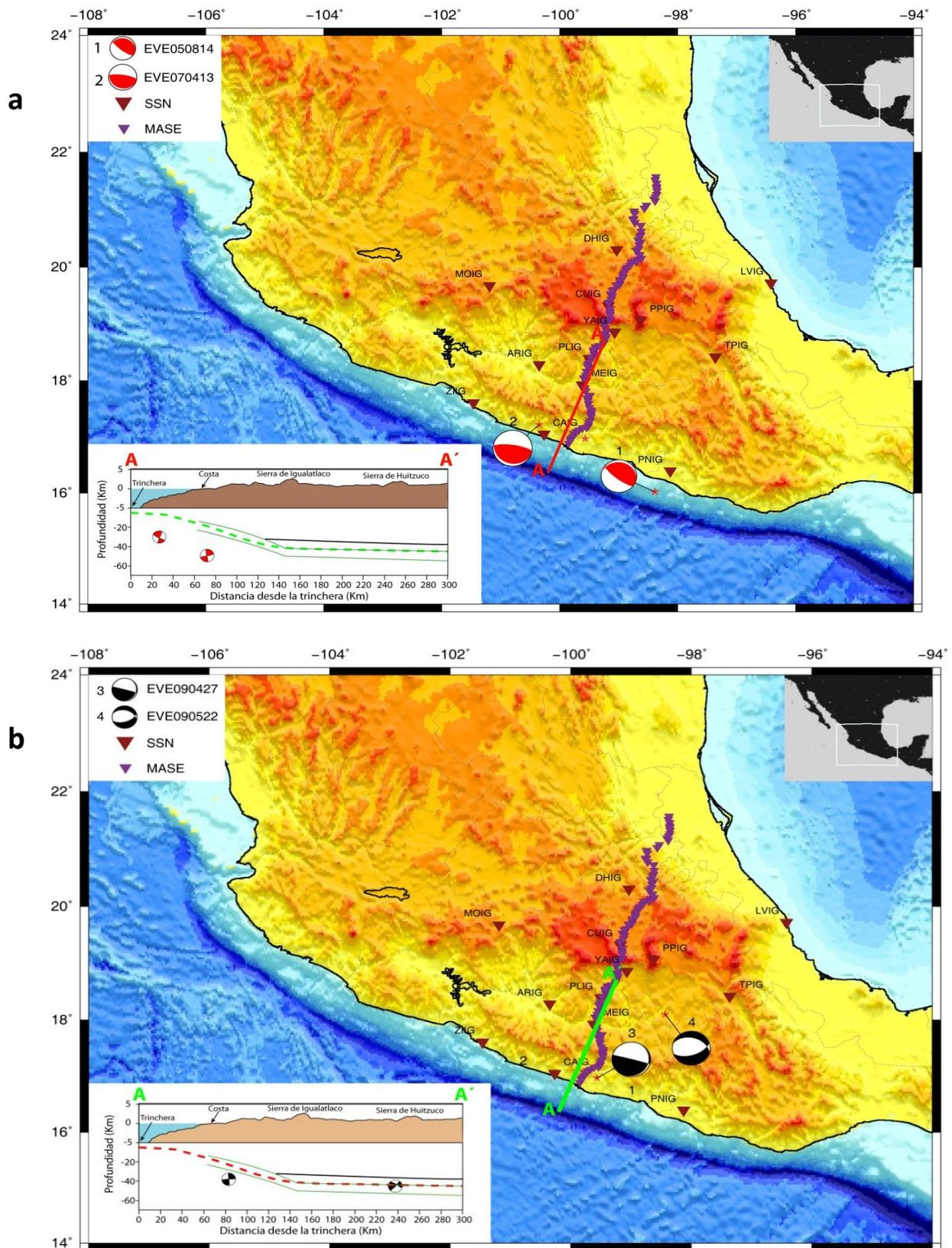
Figura 3.11 Imagen (a) Eventos 1 y 2, imagen (b) Eventos 3 y 4 (Tabla 3.1), estaciones empleadas para su análisis (triángulos) y sección AA' ilustrando la localización hipocentral y los mecanismos focales correspondientes (modificado de Pacheco y Singh, 2010 y UNAM Seismology Group, 2010).
