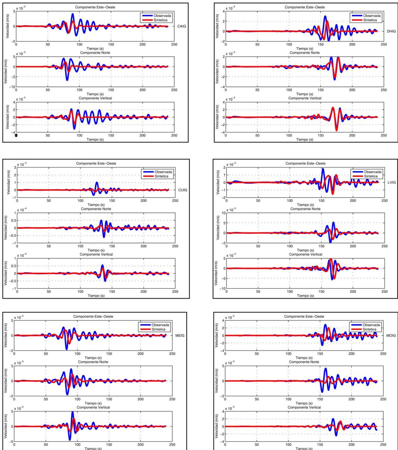
Figura 17 A Comparaciones de sismogramas Observados y Sintéticos para el sismo del 14 de Agosto del 2005, Mw 5.4, registrado por 9 estaciones del SSN dentro de nuestra área de estudio (cuadro rojo) empleando el modelo cortical Iglesias et al., 2010. Se presentan las 3 componentes (Este, Norte, Vertical), la línea azul representa los sismogramas observados y la roja los sintéticos, ambos filtrados con un filtro pasabajas a 10 s (0.1 Hz). Esta es la sección A con 6 estaciones.
