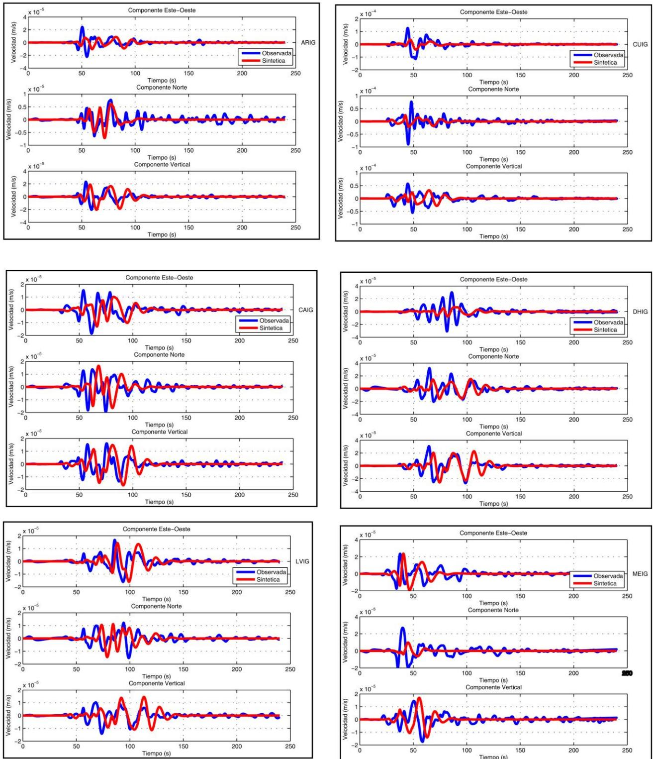
Figura 5-A Comparaciones de sismogramas Observados y Sintéticos para el sismo del 22 de Mayo del 2009, Mw 5.6, registrado por 12 estaciones del SSN dentro de nuestra área de estudio (cuadro rojo) empleando el modelo cortical PREM (1982). Se presentan las 3 componentes (Este, Norte, Vertical), la línea azul representa los sismogramas observados y la roja los sintéticos, ambos filtrados con un filtro pasabajos a 10 s (0.1 Hz). Esta es la sección A con 6 estaciones.
