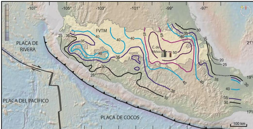
Fig. 2.3 Espesores de la corteza en la parte central de México, ( tomado y modificado de Ferrari et al., en prensa).
