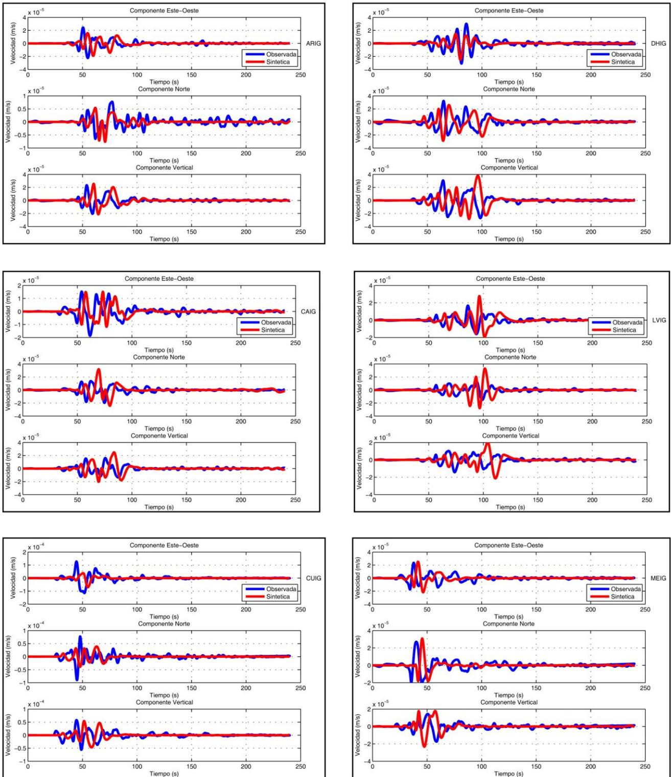
Figura 27 B Comparaciones de sismogramas Observados y Sintéticos para el sismo del 22 de Mayo del 2009, Mw 5.6, registrado por 12 estaciones del SSN dentro de nuestra área de estudio (cuadro rojo) empleando el modelo cortical Modificado. Se presentan las 3 componentes (Este, Norte, Vertical), la línea azul representa los sismogramas observados y la roja los sintéticos, ambos filtrados con un filtro pasabajos a 10 s (0.1 Hz). Esta es la sección B con 6 estaciones.
