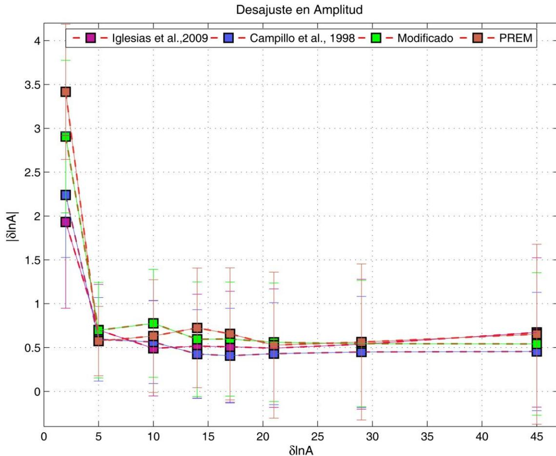
Figura 5.11 Desajuste promedio en amplitud (valor absoluto) a lo largo del arreglo MASE por período para el evento 2 EVE070413 en los modelos de Iglesias et al., 2010 (morado), Campillo et al., 1996 (azul), PREM (1982) (pardo) y Modificado (verde).
