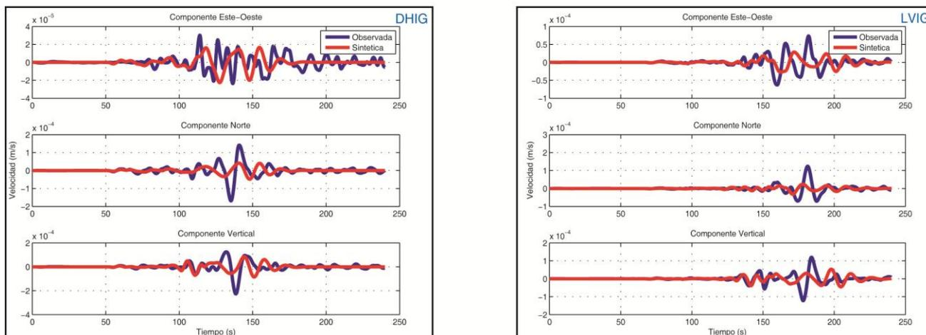
Figura 3-B Comparaciones de sismogramas Observados y Sintéticos para el sismo de Atoyac Mw 5.9 del 13 de Abril de 2007, registrado por 8 estaciones del SSN dentro de nuestra área de estudio (cuadro rojo) empleando el modelo cortical PREM (1982). Se presentan las 3 componentes (Este, Norte, Vertical), la línea azul representa los sismogramas observados y la roja los sintéticos, ambos filtrados con un filtro pasabajos a 10 s (0.1 Hz). Esta es la sección B con 2 estaciones.
