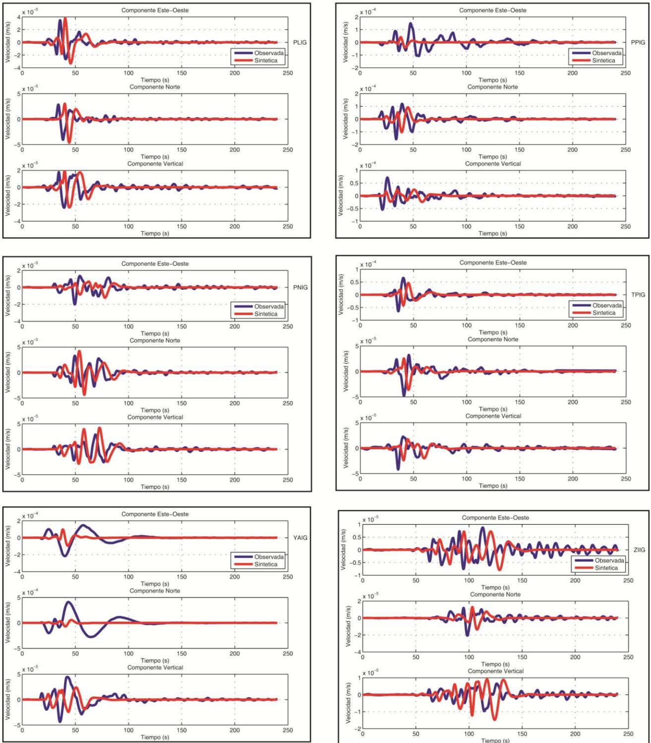
Figura 14 B Comparaciones de sismogramas Observados y Sintéticos para el sismo del 22 de Mayo del 2009, Mw 5.6, registrado por 12 estaciones del SSN dentro de nuestra área de estudio (cuadro rojo) empleando el modelo cortical Campillo et al., 1996. Se presentan las 3 componentes (Este, Norte, Vertical), la línea azul representa los sismogramas observados y la roja los sintéticos, ambos filtrados con un filtro pasabajas a 10 s (0.1 Hz). Esta es la sección B con 6 estaciones.
