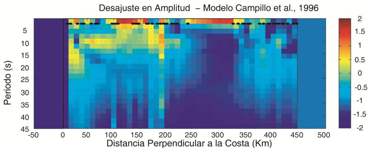
Figura 5.1 Resultados del análisis espectral para el evento 1 EVE050814 en el modelo cortical de velocidades propuesto por Campillo et al., 1996 (Sección 3.4), Modelo cortical de velocidades de ondas S (arriba), desajuste en fase (en medio) y desajuste en amplitud (abajo) para periodos de 2-50 s (0.5-0.02 Hz). Los puntos negros muestran las estaciones usadas en el análisis.
