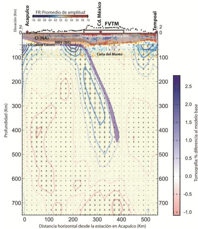
Figura 2.5 Interpretación de los datos obtenidos con funciones receptor a lo largo del perfil MASE, muestra que la placa en subducción está truncada entre 450-500 km y un posible segmento desprendido por debajo de los 600 km, CI= Corteza Inferior, NA= Norte América, CO= Corteza Continental, MBV= Manto de baja velocidad,( tomado y modificado de Pérez-Campos et al., 2008).
