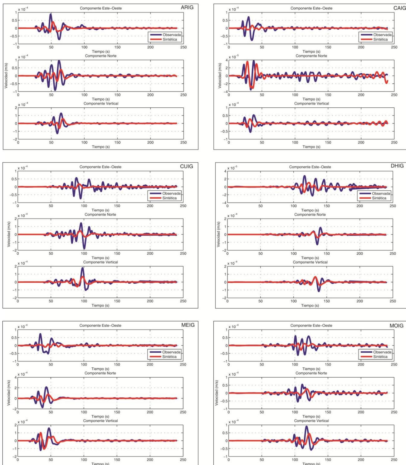
Figura 21 A Comparaciones de sismogramas Observados y Sintéticos para el sismo del 27 de Abril del 2009, Mw 5.8, registrado por 11 estaciones del SSN dentro de nuestra área de estudio (cuadro rojo) empleando el modelo cortical Iglesias et al., 2010. Se presentan las 3 componentes (Este, Norte, Vertical), la línea azul representa los sismogramas observados y la roja los sintéticos, ambos filtrados con un filtro pasabajas a 10 s (0.1 Hz). Esta es la sección A con 6 estaciones.
