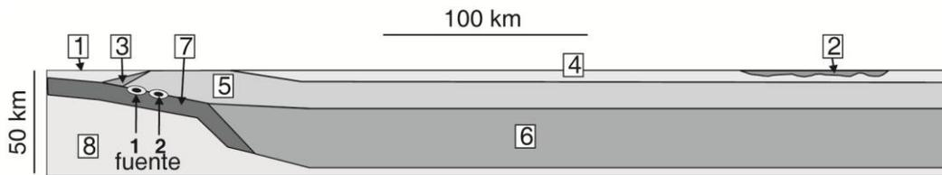
*Figura 2.6* Modelo litosférico bidimensional entre la costa de Guerrero (izquierda) y la Faja Volcánica Transmexicana (capa 2) usado por Shapiro et al. (2002) para la simulación numérica de terremotos de subducción; (1) capa de agua, (3) prisma de acreción, (4, 5, 6) tres capas de corteza, (7) corteza oceánica, (8) manto (tomado y modificado de Shapiro et. al., 2002).
