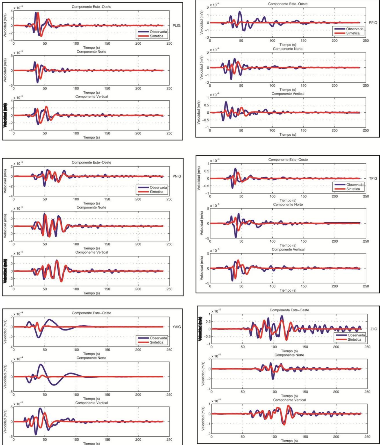
Figura 22 B Comparaciones de sismogramas Observados y Sintéticos para el sismo del 22 de Mayo del 2009, Mw 5.6, registrado por 12 estaciones del SSN dentro de nuestra área de estudio (cuadro rojo) empleando el modelo cortical Iglesias et al., 2010. Se presentan las 3 componentes (Este, Norte, Vertical), la línea azul representa los sismogramas observados y la roja los sintéticos, ambos filtrados con un filtro pasabajos a 10 s (0.1 Hz). Esta es la sección B con 6 estaciones.
