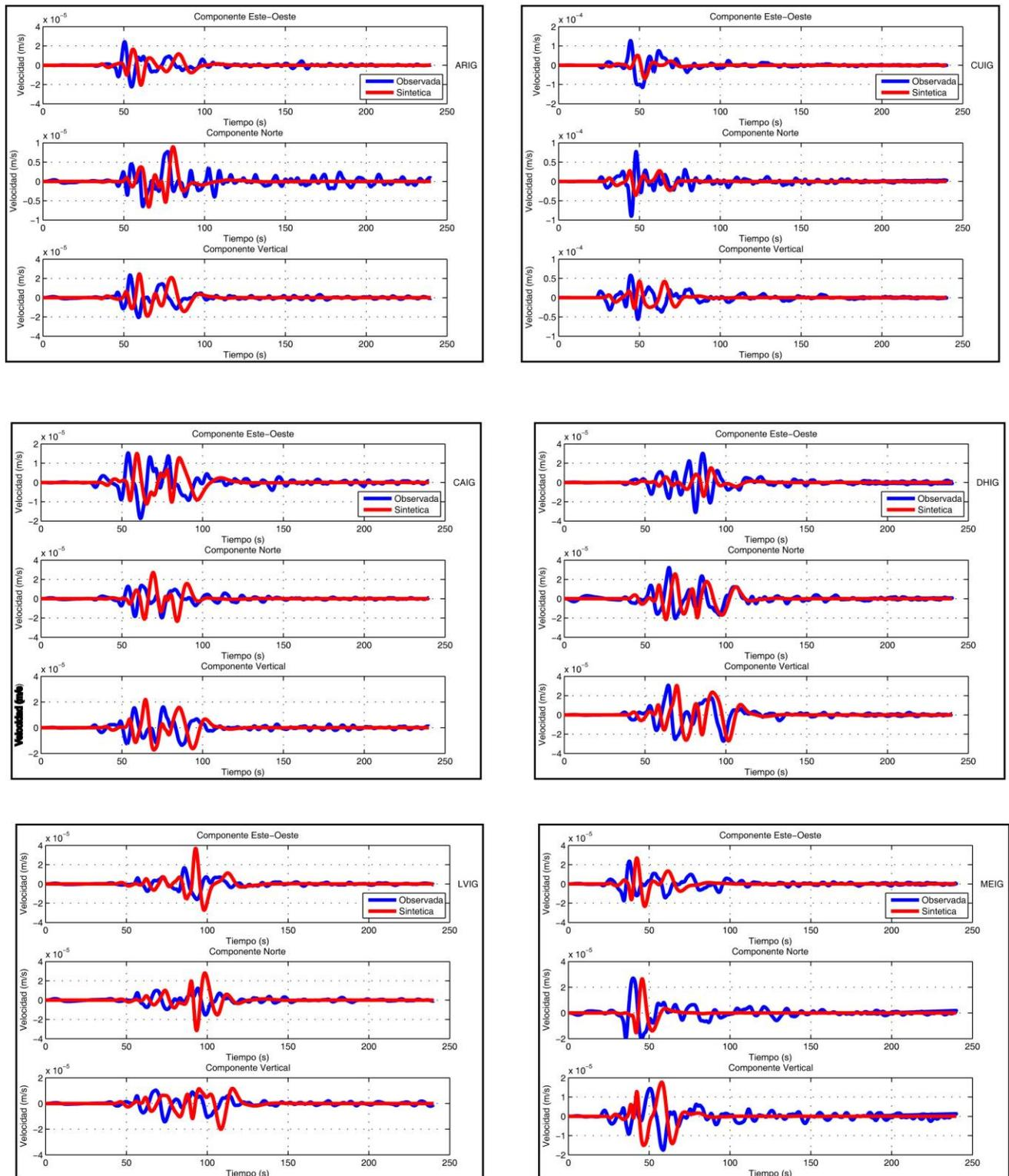
Figura 14 A Comparaciones de sismogramas Observados y Sintéticos para el sismo del 22 de Mayo del 2009, Mw 5.6, registrado por 12 estaciones del SSN dentro de nuestra área de estudio (cuadro rojo) empleando el modelo cortical Campillo et al., 1996. Se presentan las 3 componentes (Este, Norte, Vertical), la línea azul representa los sismogramas observados y la roja los sintéticos, ambos filtrados con un filtro pasabajas a 10 s (0.1 Hz). Esta es la sección A con 6 estaciones.
