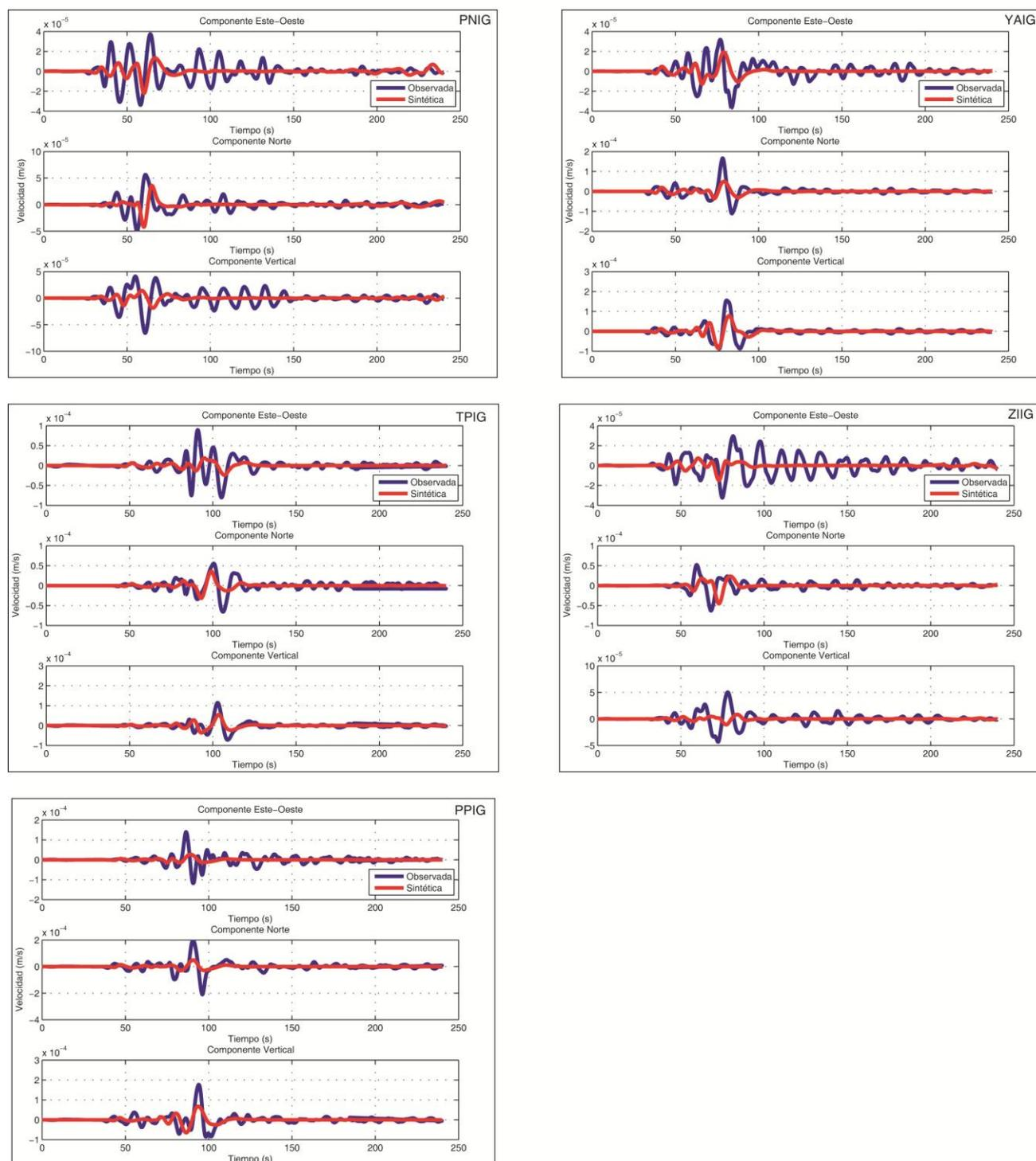
Figura 26 B Comparaciones de sismogramas Observados y Sintéticos para el sismo del 27 de Abril del 2009, Mw 5.8, registrado por 11 estaciones del SSN dentro de nuestra área de estudio (cuadro rojo) empleando el modelo cortical Modificado. Se presentan las 3 componentes (Este, Norte, Vertical), la línea azul representa los sismogramas observados y la roja los sintéticos, ambos filtrados con un filtro pasabajas a 10 s (0.1 Hz). Esta es la sección B con 5 estaciones.
