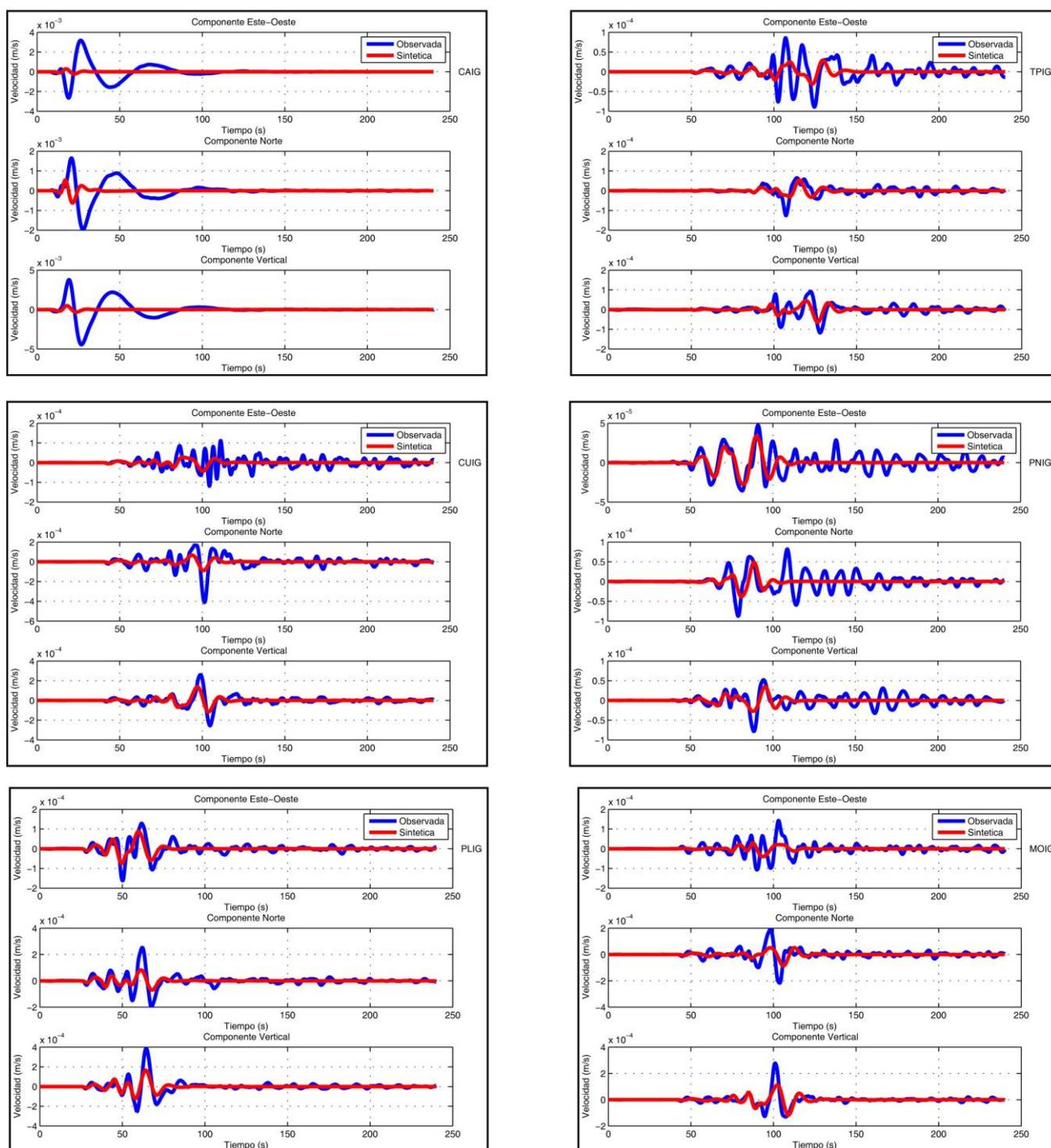
Figura 20 A Comparaciones de sismogramas Observados y Sintéticos para el sismo de Atoyac Mw 5.9 del 13 de Abril de 2007, registrado por 8 estaciones del SSN dentro de nuestra área de estudio (cuadro rojo) empleando el modelo cortical Iglesias et al., 2010. Se presentan las 3 componentes (Este, Norte, Vertical), la línea azul representa los sismogramas observados y la roja los sintéticos, ambos filtrados con un filtro pasabajas a 10 s (0.1 Hz). Esta es la sección A con 6 estaciones.
