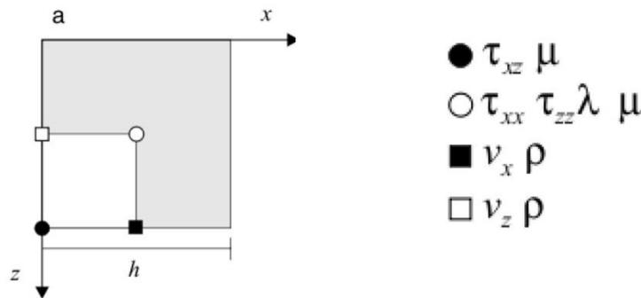
Figura 3.1 Plantilla numérica para el “staggered-grid” aproximada para las diferencias finitas estándar (Madariaga, 1976),  $h$  es el incremento espacial de la malla,  $(\tau_{xx}, \tau_{zz}, \tau_{xz})$  es el tensor de esfuerzos de segundo orden, el vector de velocidad de la partícula es representado por  $(v_x, v_z)$ ,  $\lambda$  y  $\mu$  son los coeficientes de Lamé y  $\rho$ , la densidad. (tomado de Cruz-Atienza et al., 2004).
