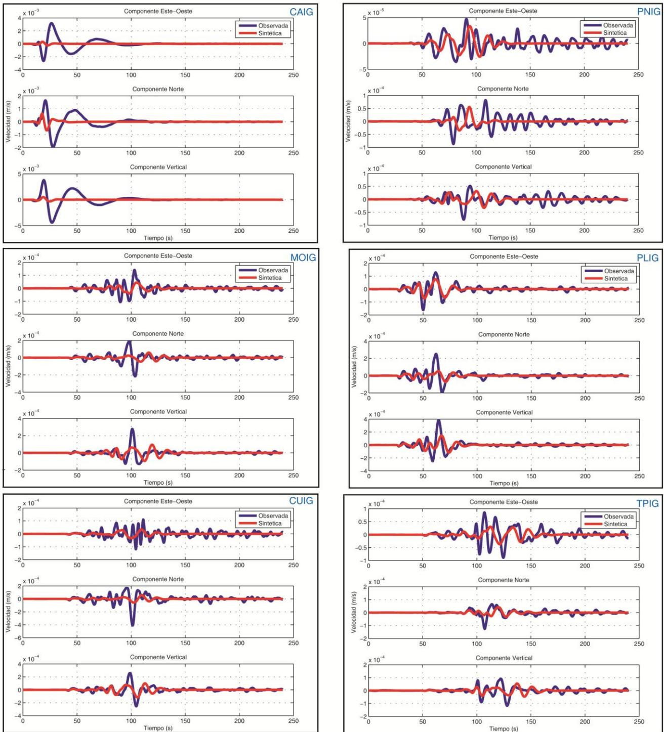
Figura 3-A Comparaciones de sismogramas Observados y Sintéticos para el sismo de Atoyac Mw 5.9 del 13 de Abril de 2007, registrado por 8 estaciones del SSN dentro de nuestra área de estudio (cuadro rojo) empleando el modelo cortical PREM (1982). Se presentan las 3 componentes (Este, Norte, Vertical), la línea azul representa los sismogramas observados y la roja los sintéticos, ambos filtrados con un filtro pasabajos a 10 s (0.1 Hz). Esta es la sección A con 6 estaciones.
