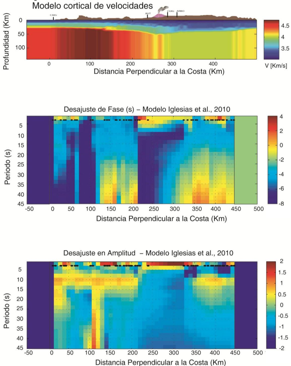
Figura 5.2 Resultados del análisis espectral para el evento 1 EVE050814 en el modelo cortical de velocidades propuesto por Iglesias et al., 2010 (Sección 3.4), Modelo cortical de velocidades de ondas S (arriba), desajuste en fase (en medio) y desajuste en amplitud (abajo) para periodos de 2-50 s (0.5-0.02 Hz). Los puntos negros muestran las estaciones usadas en el análisis.
