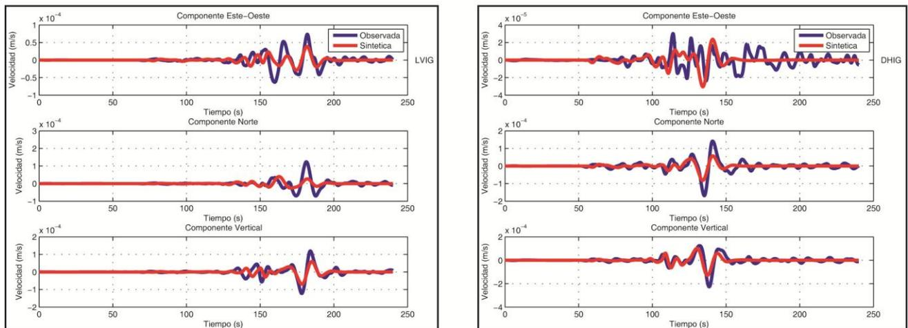
Figura 20 B Comparaciones de sismogramas Observados y Sintéticos para el sismo de Atoyac Mw 5.9 del 13 de Abril de 2007, registrado por 8 estaciones del SSN dentro de nuestra área de estudio (cuadro rojo) empleando el modelo cortical Iglesias et al., 2010. Se presentan las 3 componentes (Este, Norte, Vertical), la línea azul representa los sismogramas observados y la roja los sintéticos, ambos filtrados con un filtro pasabajas a 10 s (0.1 Hz). Esta es la sección B con 2 estaciones.
