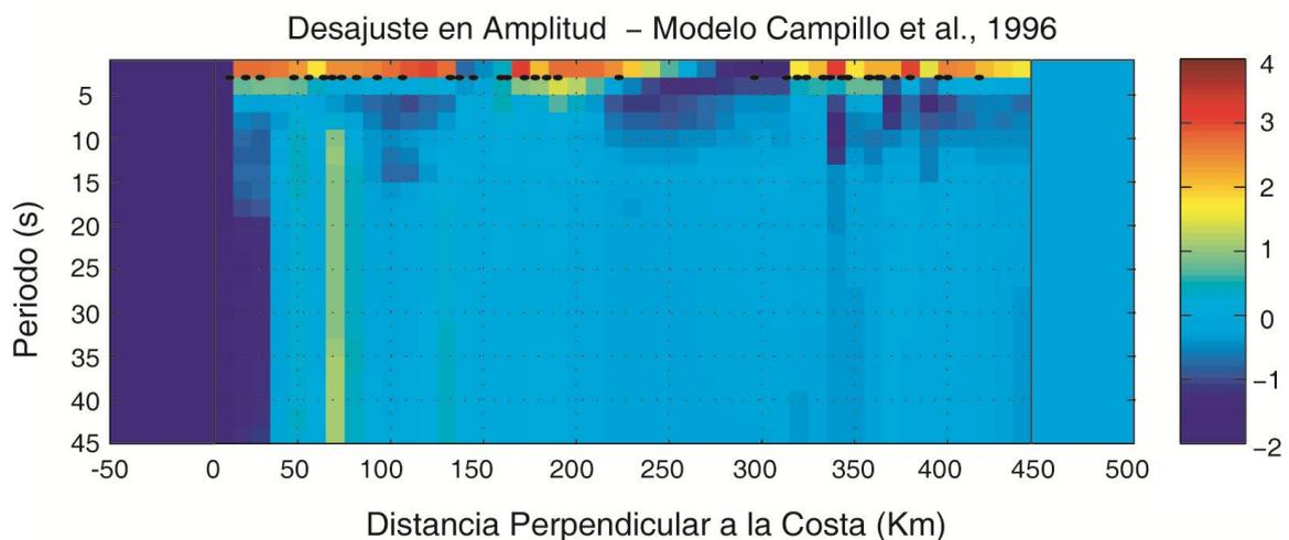
Figura 5.4 Resultados del análisis espectral para el evento 2 EVE070413 en el modelo cortical de velocidades propuesto por Campillo et al., 1996 (Sección 3.4), Modelo cortical de velocidades de ondas S (arriba), desajuste en fase (en medio) y desajuste en amplitud (abajo) para periodos de 2-50 s (0.5-0.02 Hz). Los puntos negros muestran las estaciones usadas en el análisis.
