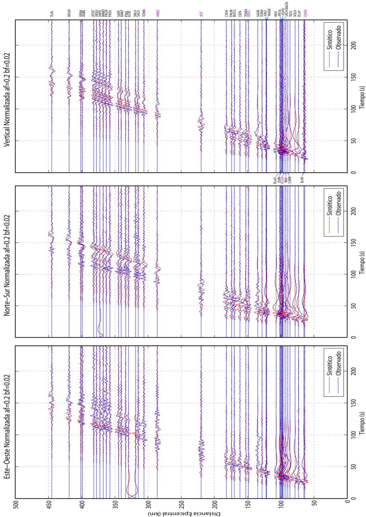
Figura 11 Comparaciones de sismogramas Observados y Sintéticos para el sismo de Atoyac del 13 de abril del 2007, Mw 5.9, empleando el modelo cortical Campillo et al., 1996 a lo largo de 45 estaciones del arreglo MASE. Se presentan las 3 componentes (Este, Norte, Vertical) los sismogramas están ordenados por distancia epicentral a partir de la costa (Acapulco), la línea azul representa los sismogramas observados y la roja los sintéticos, ambos filtrados con un filtro pasabajas a 5 s (0.2 Hz).
