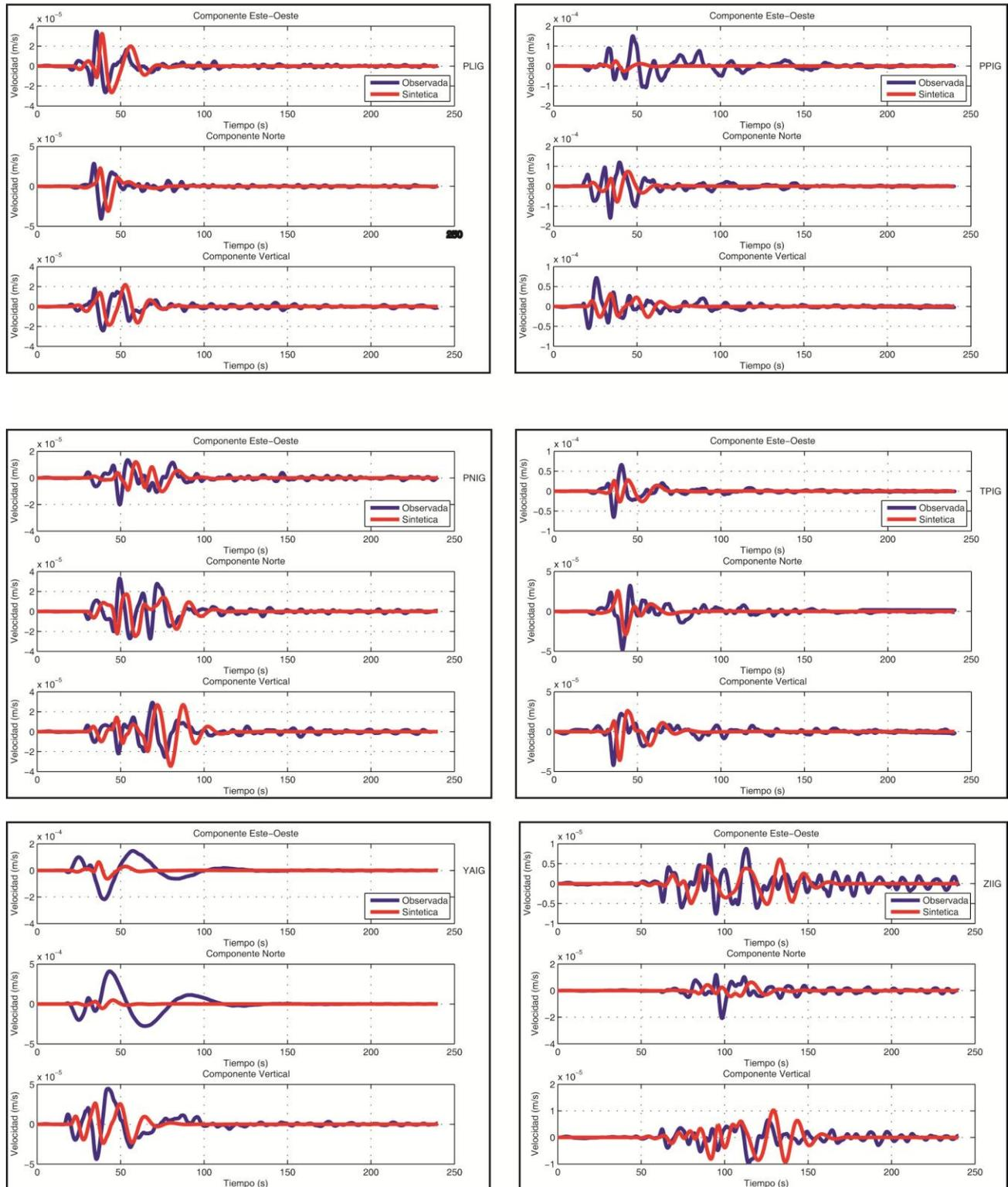
Figura 5-B Comparaciones de sismogramas Observados y Sintéticos para el sismo del 22 de Mayo del 2009, Mw 5.6, registrado por 12 estaciones del SSN dentro de nuestra área de estudio (cuadro rojo) empleando el modelo cortical PREM (1982). Se presentan las 3 componentes (Este, Norte, Vertical), la línea azul representa los sismogramas observados y la roja los sintéticos, ambos filtrados con un filtro pasabajas a 10 s (0.1 Hz). Esta es la sección B con 6 estaciones.
