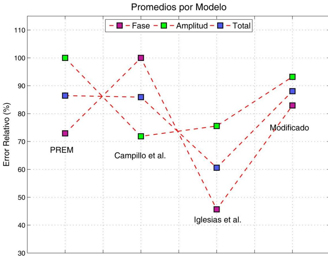
Figura 5.12 Promedios finales en porcentaje de error relativo para el evento EVE070413, con los 4 modelos que se utilizaron para obtener las medidas de *multi-taper* que son: modelo PREM (1982), modelo Campillo et al., 1996, modelo Iglesias et al., 2010 y modelo Modificado. Para cada modelo se presenta el porcentaje de error relativo en fase (morado), amplitud (verde) y el Total (azul).
