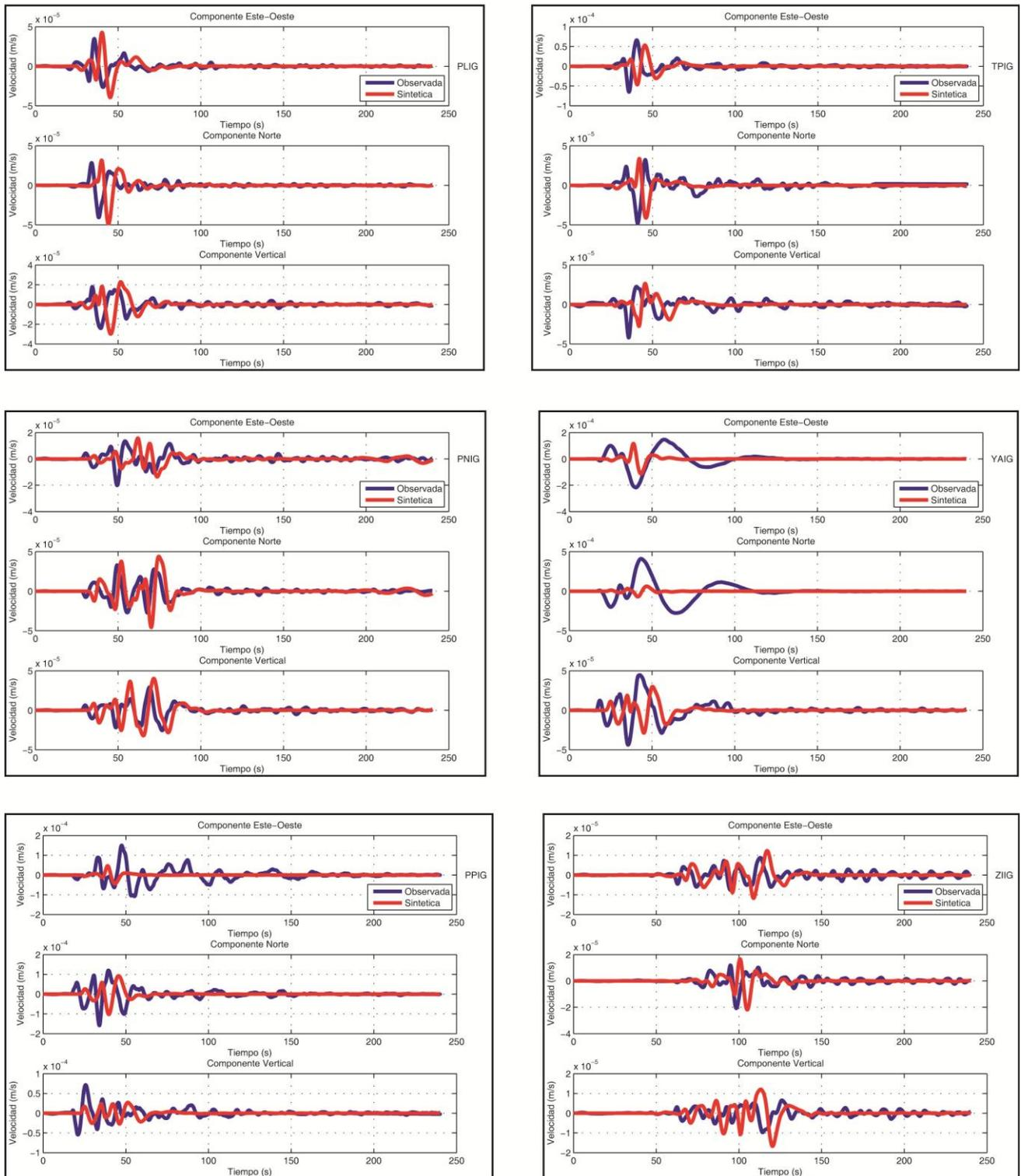
Figura 27 A Comparaciones de sismogramas Observados y Sintéticos para el sismo del 22 de Mayo del 2009, Mw 5.6, registrado por 12 estaciones del SSN dentro de nuestra área de estudio (cuadro rojo) empleando el modelo cortical Modificado. Se presentan las 3 componentes (Este, Norte, Vertical), la línea azul representa los sismogramas observados y la roja los sintéticos, ambos filtrados con un filtro pasabajos a 10 s (0.1 Hz). Esta es la sección A con 6 estaciones.
