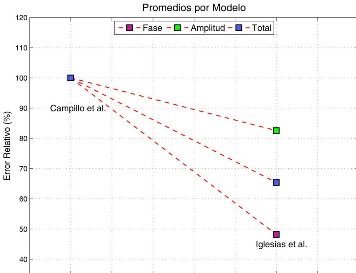
Figura 5.9 Promedios finales en porcentaje de error relativo para el evento EVE050814, con los dos modelos que se utilizaron para obtener las medidas de *multi-taper* que son: modelo Campillo et al., 1996, modelo Iglesias et al., 2010, para cada modelo se presenta el porcentaje de error relativo en fase (cuadro morado), amplitud (cuadro verde) y el Total (cuadro azul).
