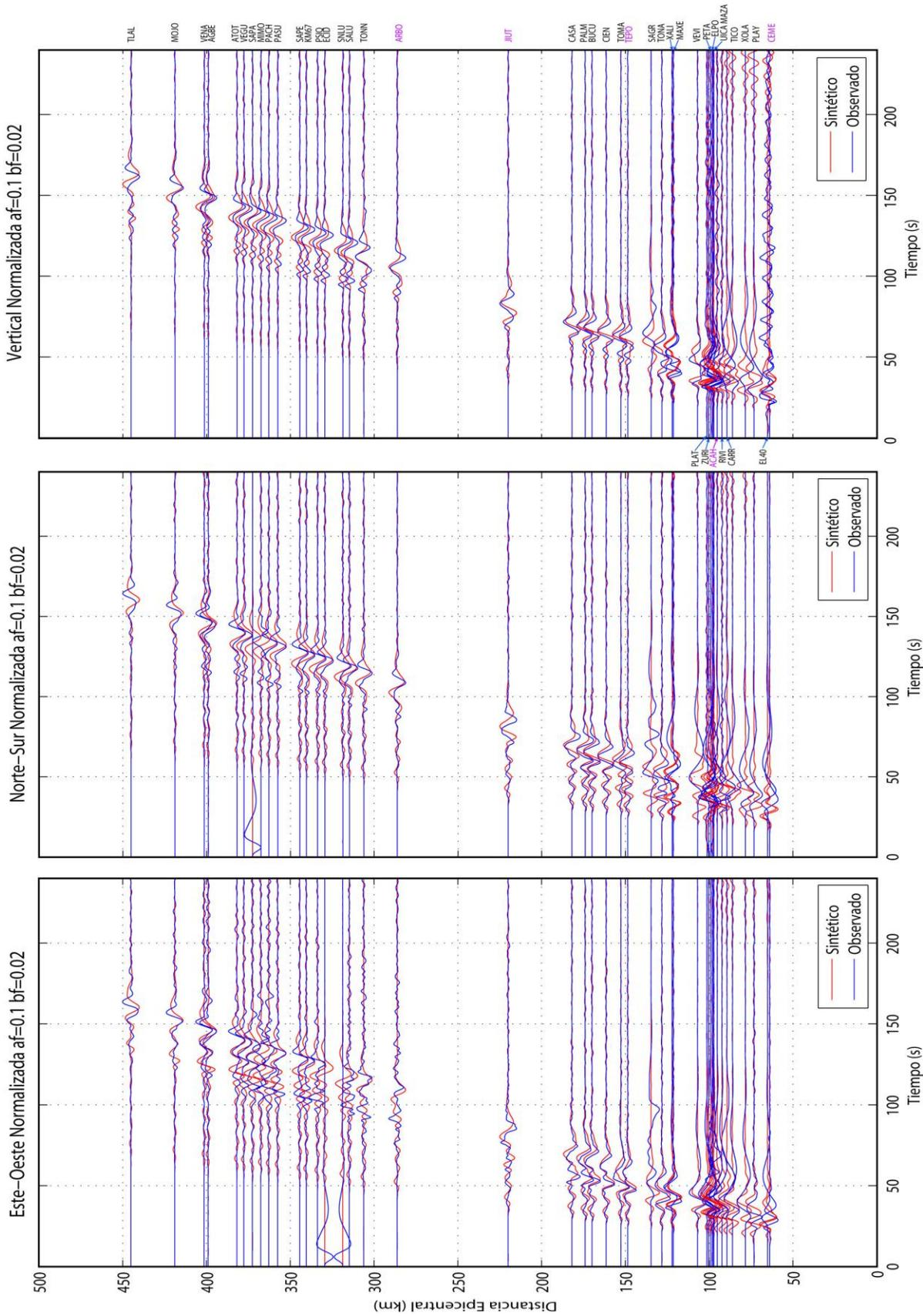
Figura 4.27 Comparaciones de sismogramas Observados y Sintéticos para el sismo de Atoyac del 13 de abril del 2007, Mw 5.9, empleando el modelo Modificado a lo largo de 45 estaciones del arreglo MASE. Se presentan las 3 componentes (Este, Norte, Vertical) los sismogramas están ordenados por distancia epicentral a partir de la costa (Acapulco), la línea azul representa los sismogramas observados y la roja los sintéticos, ambos filtrados con un filtro pasabajas a 10 s (0.1 Hz).
