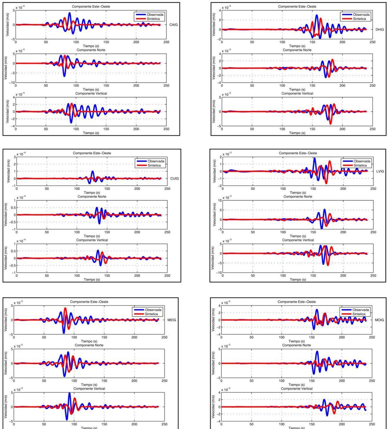
Figura 9- A Comparaciones de sismogramas Observados y Sintéticos para el sismo del 14 de Agosto del 2005, Mw 5.4, registrado por 9 estaciones del SSN dentro de nuestra área de estudio (cuadro rojo) empleando el modelo cortical Campillo et al., 1996. Se presentan las 3 componentes (Este, Norte, Vertical), la línea azul representa los sismogramas observados y la roja los sintéticos, ambos filtrados con un filtro pasabajos a 10 s (0.1 Hz). Esta es la sección A con 6 estaciones.
