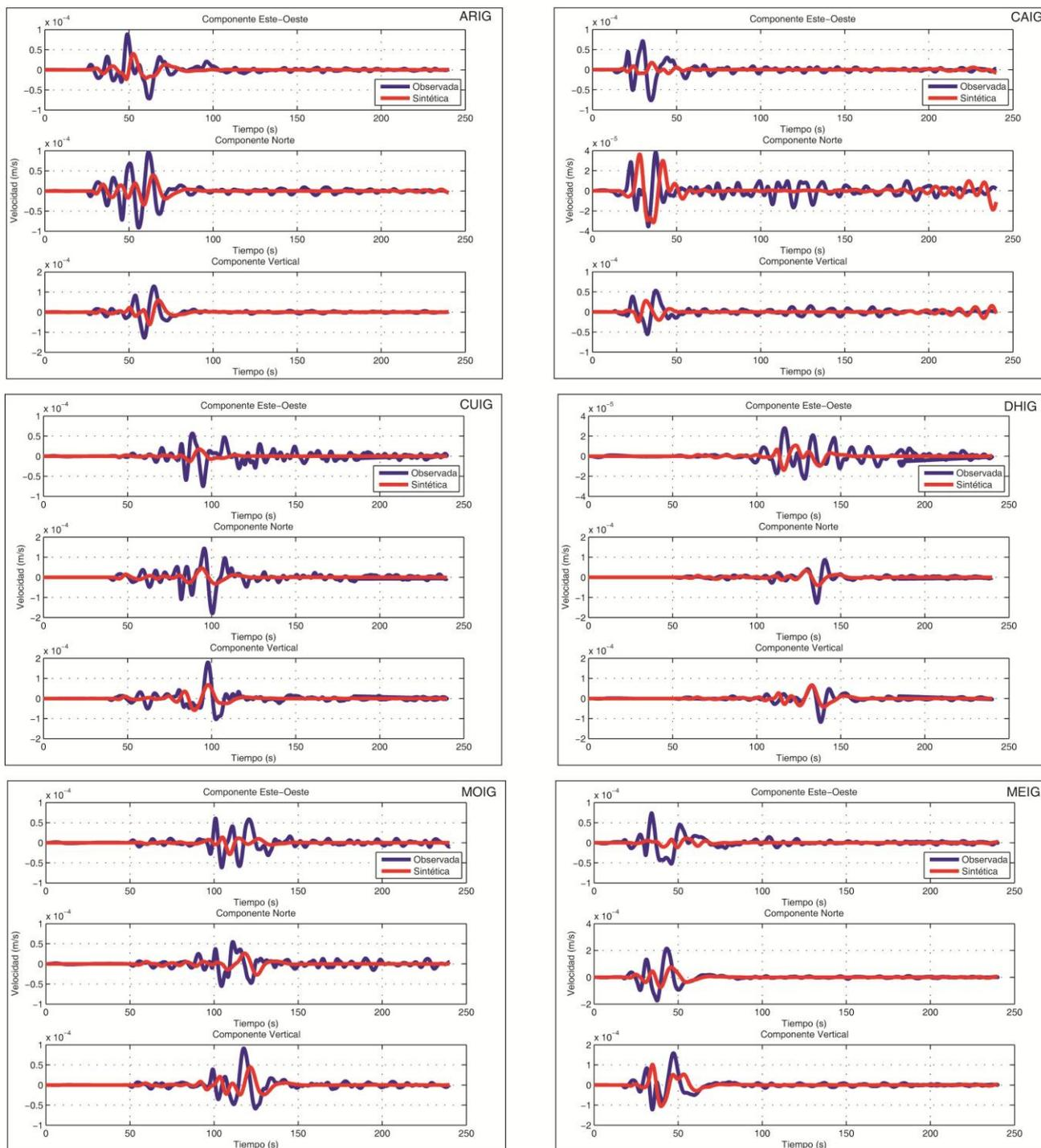
Figura 26 A Comparaciones de sismogramas Observados y Sintéticos para el sismo del 27 de Abril del 2009, Mw 5.8, registrado por 11 estaciones del SSN dentro de nuestra área de estudio (cuadro rojo) empleando el modelo cortical Modificado. Se presentan las 3 componentes (Este, Norte, Vertical), la línea azul representa los sismogramas observados y la roja los sintéticos, ambos filtrados con un filtro pasabajos a 10 s (0.1 Hz). Esta es la sección A con 6 estaciones.
