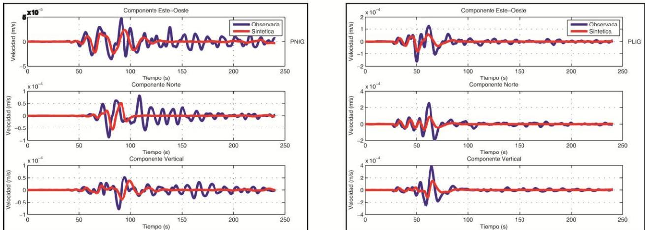
Figura 25 B Comparaciones de sismogramas Observados y Sintéticos para el sismo de Atoyac Mw 5.9 del 13 de Abril de 2007, registrado por 8 estaciones del SSN dentro de nuestra área de estudio (cuadro rojo) empleando el modelo cortical Modificado. Se presentan las 3 componentes (Este, Norte, Vertical), la línea azul representa los sismogramas observados y la roja los sintéticos, ambos filtrados con un filtro pasabajas a 10 s (0.1 Hz). Esta es la sección B con 2 estaciones.
