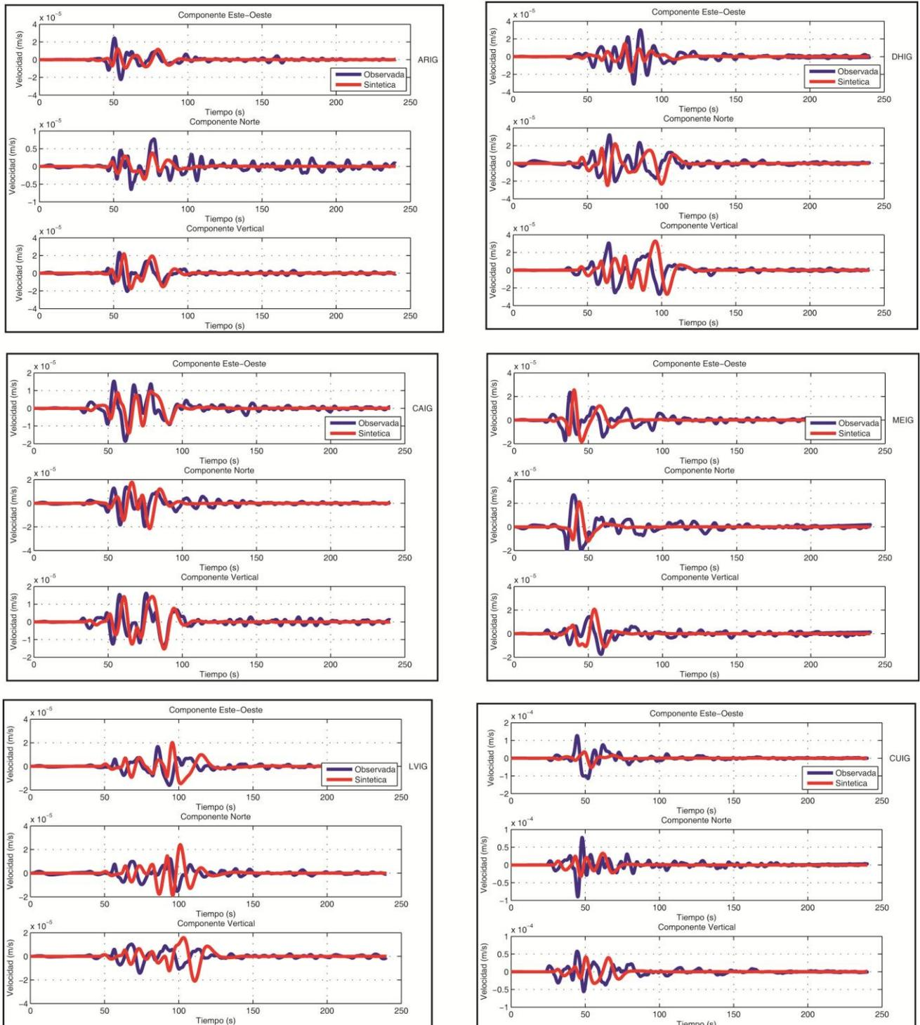
Figura 22 A Comparaciones de sismogramas Observados y Sintéticos para el sismo del 22 de Mayo del 2009, Mw 5.6, registrado por 12 estaciones del SSN dentro de nuestra área de estudio (cuadro rojo) empleando el modelo cortical Iglesias et al., 2010. Se presentan las 3 componentes (Este, Norte, Vertical), la línea azul representa los sismogramas observados y la roja los sintéticos, ambos filtrados con un filtro pasabajos a 10 s (0.1 Hz). Esta es la sección A con 6 estaciones.
