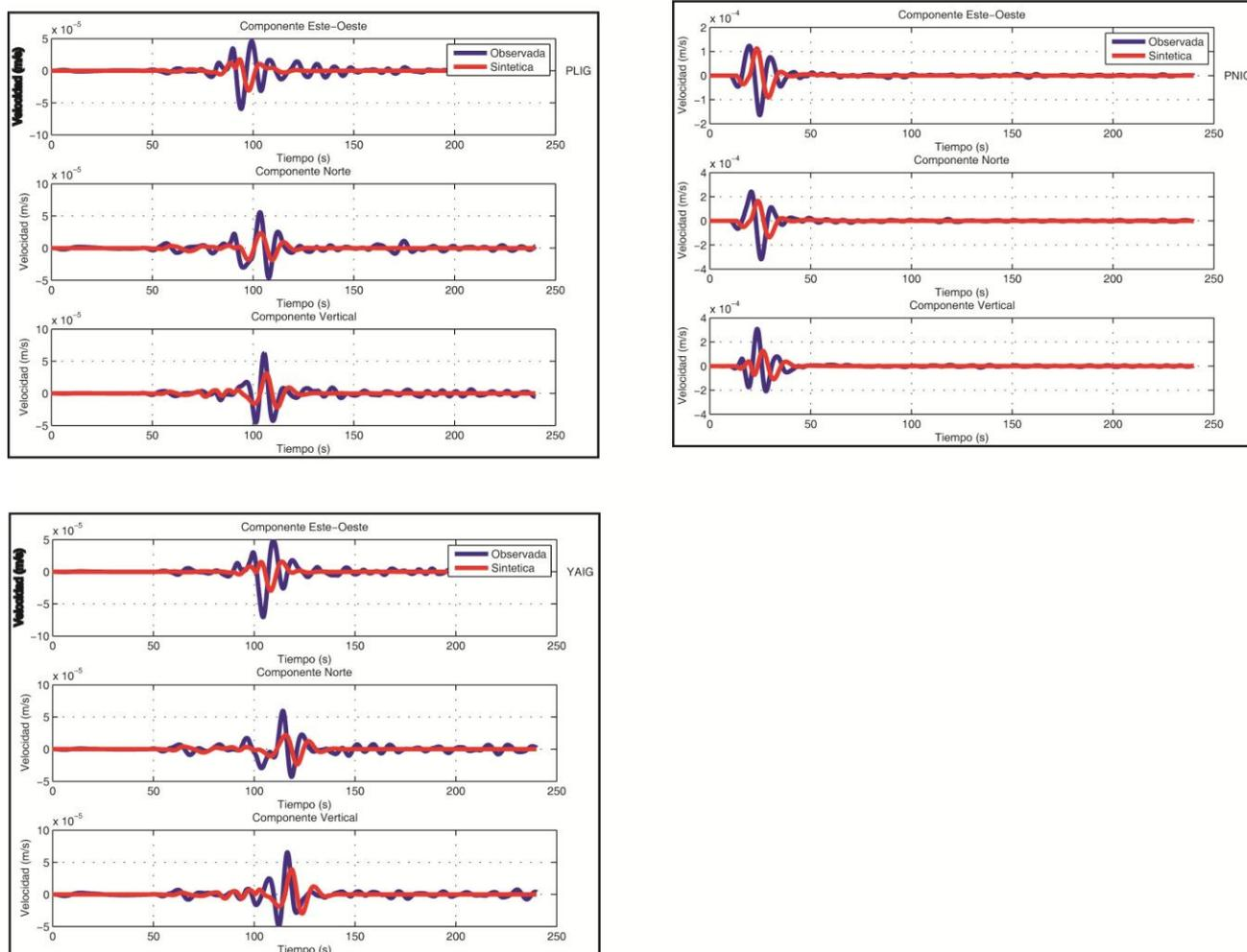
Figura 17 B Comparaciones de sismogramas Observados y Sintéticos para el sismo del 14 de Agosto del 2005, Mw 5.4, registrado por 9 estaciones del SSN dentro de nuestra área de estudio (cuadro rojo) empleando el modelo cortical Iglesias et al., 2010. Se presentan las 3 componentes (Este, Norte, Vertical), la línea azul representa los sismogramas observados y la roja los sintéticos, ambos filtrados con un filtro pasabajas a 10 s (0.1 Hz). Esta es la sección B con 3 estaciones.
