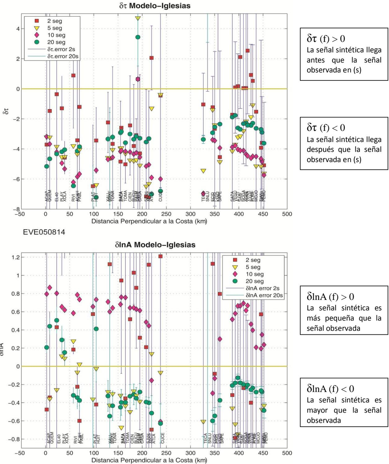
Figura 4.35 Medidas de *multi-taper* entre 2 y 20 s (i.e. de 0.5 a 0.05 Hz) con sus respectivos errores (barras verticales) para las discrepancias en fase  $\delta\tau(f)$  (i.e. tiempos de arribo) (arriba) y en amplitud  $\delta\ln A(f)$  (abajo). Para este evento y este modelo se emplearon 44 estaciones. Los nombres de las estaciones se encuentran en la parte inferior de cada imagen.
