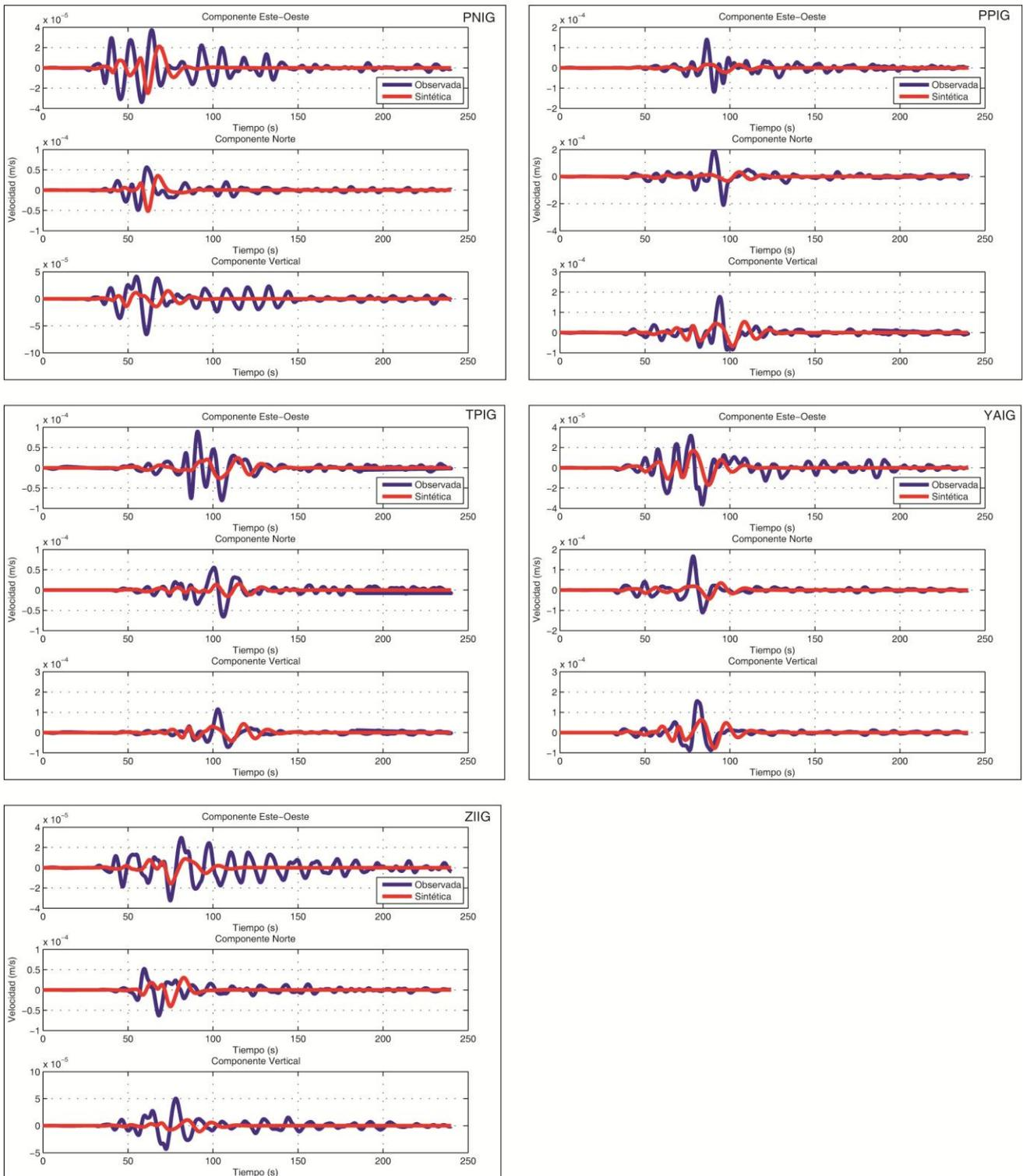
Figura 4 B Comparaciones de sismogramas Observados y Sintéticos para el sismo del 27 de Abril del 2009, Mw 5.8, registrado por 11 estaciones del SSN dentro de nuestra área de estudio (cuadro rojo) empleando el modelo cortical PREM (1982). Se presentan las 3 componentes (Este, Norte, Vertical), la línea azul representa los sismogramas observados y la roja los sintéticos, ambos filtrados con un filtro pasabajas a 10 s (0.1 Hz). Esta es la sección B con 5 estaciones.
