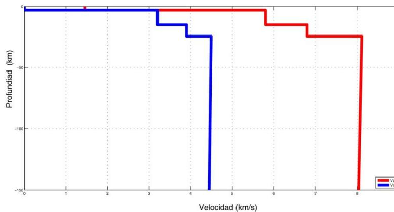
Figura 3.13 Velocidades para las ondas  $v_p$  y  $v_s$ , (color rojo y azul respectivamente), hasta 150 km de profundidad,(valores en la tabla 3.1).
