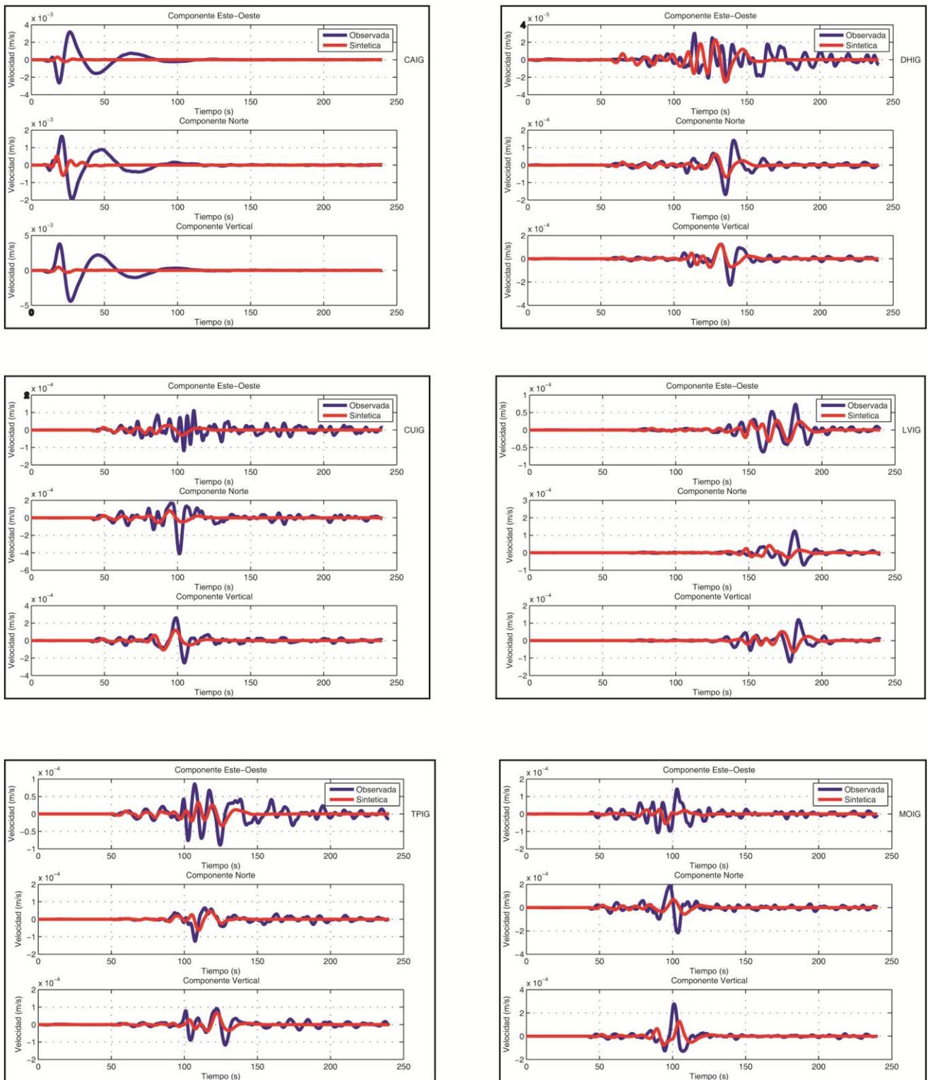
Figura 25 A Comparaciones de sismogramas Observados y Sintéticos para el sismo de Atoyac Mw 5.9 del 13 de Abril de 2007, registrado por 8 estaciones del SSN dentro de nuestra área de estudio (cuadro rojo) empleando el modelo cortical Modificado. Se presentan las 3 componentes (Este, Norte, Vertical), la línea azul representa los sismogramas observados y la roja los sintéticos, ambos filtrados con un filtro pasabajas a 10 s (0.1 Hz). Esta es la sección A con 6 estaciones.
