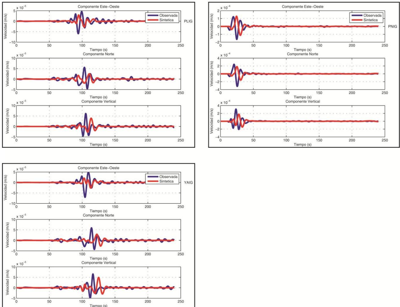
Figura 9- B Comparaciones de sismogramas Observados y Sintéticos para el sismo del 14 de Agosto del 2005, Mw 5.4, registrado por 9 estaciones del SSN dentro de nuestra área de estudio (cuadro rojo) empleando el modelo cortical Campillo et al., 1996. Se presentan las 3 componentes (Este, Norte, Vertical), la línea azul representa los sismogramas observados y la roja los sintéticos, ambos filtrados con un filtro pasabajas a 10 s (0.1 Hz). Esta es la sección B con 3 estaciones.
