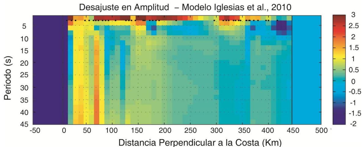
Figura 5.5 Resultados del análisis espectral para el evento 2 EVE070413 en el modelo cortical de velocidades propuesto por Modelo Iglesias et al., 2010 (Sección 3.4), Modelo cortical de velocidades de ondas S (arriba), desajuste en fase (en medio) y desajuste en amplitud (abajo) para periodos de 2-50 s (0.5-0.02 Hz). Los puntos negros muestran las estaciones usadas en el análisis.
