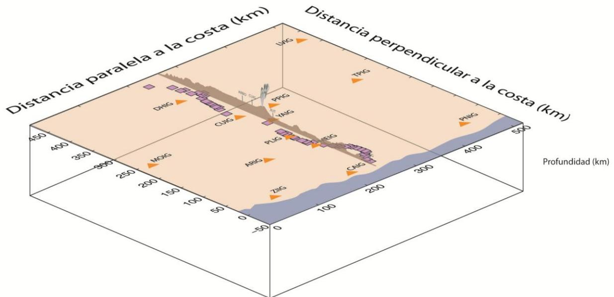
Figura 3.3 Dimensiones del modelo 3D utilizado en este trabajo para realizar las simulaciones numéricas, con una dimensión paralela a la costa de 519 km, una perpendicular a la costa de 490 km y la dimensión en profundidad del modelo numérico de 140 km. Se muestra también la localización regional del arreglo de estaciones usado para evaluar la estructura regional. Estaciones del Servicio Sismológico Nacional (parda) y del proyecto MASE (morado).
