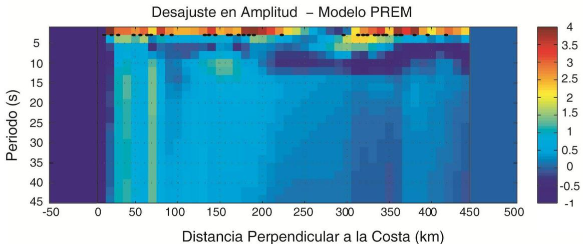
Figura 5.3 Resultados del análisis espectral para el evento 2 EVE070413 en el modelo cortical de velocidades propuesto por PREM, Dziewonski y Anderson( 1981) (Sección 3.4), Modelo cortical de velocidades de ondas S (arriba), desajuste en fase (en medio) y desajuste en amplitud (abajo) para periodos de 2-50 s (0.5-0.02 Hz). Los puntos negros muestran las estaciones usadas en el análisis.
