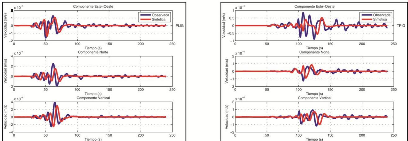
Figura 12 B Comparaciones de sismogramas Observados y Sintéticos para el sismo de Atoyac Mw 5.9 del 13 de Abril de 2007, registrado por 8 estaciones del SSN dentro de nuestra área de estudio (cuadro rojo) empleando el modelo cortical Campillo et al., 1996. Se presentan las 3 componentes (Este, Norte, Vertical), la línea azul representa los sismogramas observados y la roja los sintéticos, ambos filtrados con un filtro pasabajas a 10 s (0.1 Hz). Esta es la sección B con 2 estaciones.
