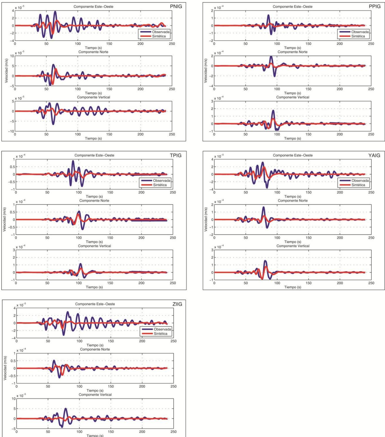
*Figura 21 B* Comparaciones de sismogramas Observados y Sintéticos para el sismo del 27 de Abril del 2009, Mw 5.8, registrado por 11 estaciones del SSN dentro de nuestra área de estudio (cuadro rojo) empleando el modelo cortical Iglesias et al., 2010. Se presentan las 3 componentes (Este, Norte, Vertical), la línea azul representa los sismogramas observados y la roja los sintéticos, ambos filtrados con un filtro pasabajos a 10 s (0.1 Hz). Esta es la sección B con 5 estaciones.
