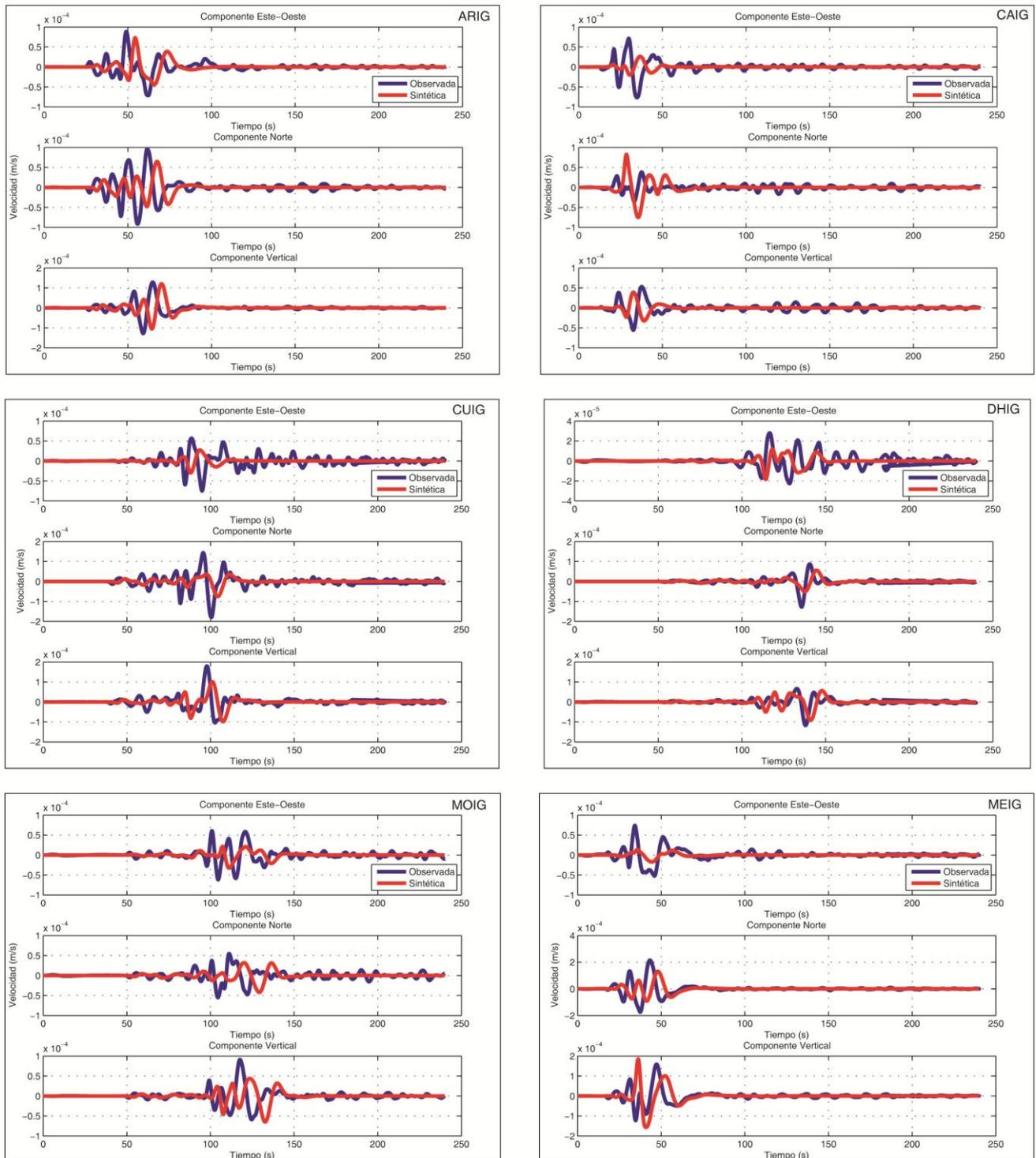
Figura 13 A Comparaciones de sismogramas Observados y Sintéticos para el sismo del 27 de Abril del 2009, Mw 5.8, registrado por 11 estaciones del SSN dentro de nuestra área de estudio (cuadro rojo) empleando el modelo cortical Campillo et al., 1996. Se presentan las 3 componentes (Este, Norte, Vertical), la línea azul representa los sismogramas observados y la roja los sintéticos, ambos filtrados con un filtro pasabajas a 10 s (0.1 Hz). Esta es la sección A con 6 estaciones.
