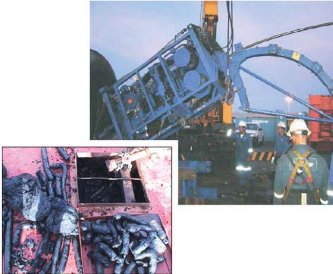
^ Utilización de tubería flexible para desobstruir una línea de conducción horizontal de 8½ pulgadas de diámetro externo. La inclinación de la estructura cabezal-inyector permitió inyectar la CT en la línea de conducción taponada (*derecha*). El agua y el gel a base de agua, ayudaron a extraer los sólidos orgánicos (*inserto de la izquierda*). (Adaptado de Torres et al, referencia 38.)
