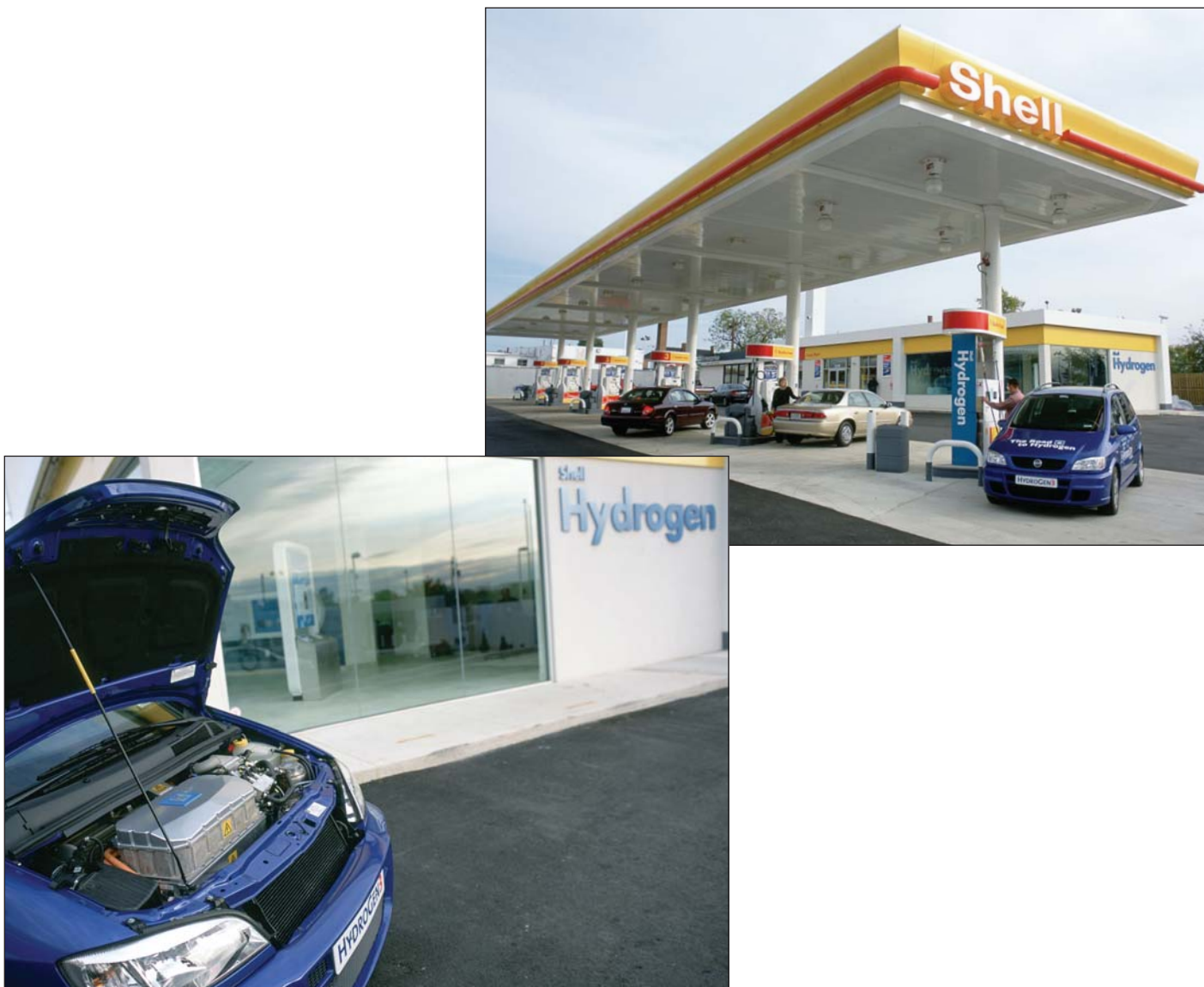
^ Estación de hidrógeno de Shell y automóvil con celdas de combustible. Esta estación de Washington, DC, está equipada tanto con surtidores de gasolina como con un surtidor de hidrógeno ( extremo superior ). El automóvil de demostración de General Motors tiene una celda de combustible de hidrógeno debajo del cofre (capó) ( extremo inferior ). La versión de este automóvil con un tanque de hidrógeno comprimido a una presión de 10,000 lpc [70 MPa] posee una autonomía de 270 km [168 millas]. (Fotografías, cortesía de Shell Hydrogen BV).
