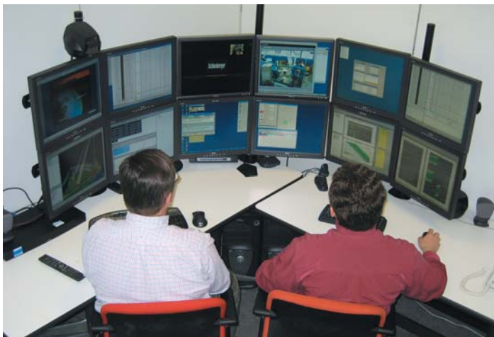
▲ Un muro de información y comunicación. El centro de control de perforación remoto del SCR, situado en Cambridge, Inglaterra, está provisto de múltiples pantallas para facilitar la vigilancia rutinaria y el análisis completo de los datos de perforación, MWD y LWD. La sala de control soporta además máximas capacidades de videoconferencia. Los datos y las comunicaciones son transmitidos a través de la red interna de Schlumberger.
