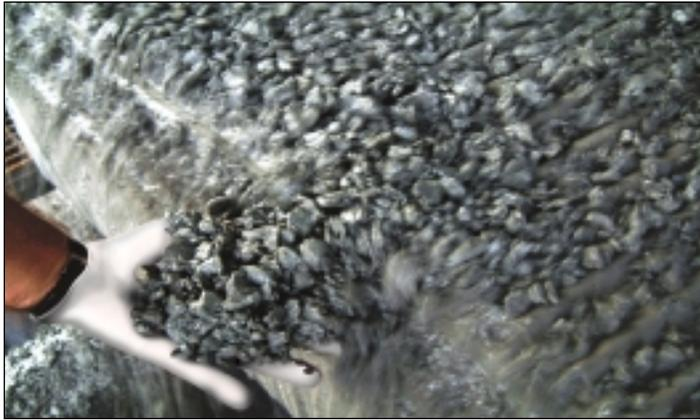
^ Control de recortes con lodo a base de silicato. El lodo SILDRIIL a base de silicato, utilizado para perforar los tramos de 12¼ pulgadas, produjo un pozo estable con un diámetro promedio de 318 mm [12.54 pulgadas]. Los recortes que aparecen atravesando las temblorinas tienen un alto nivel de integridad, lo que confirma el control de la hidratación y la dispersión de las arcillas de formación.
