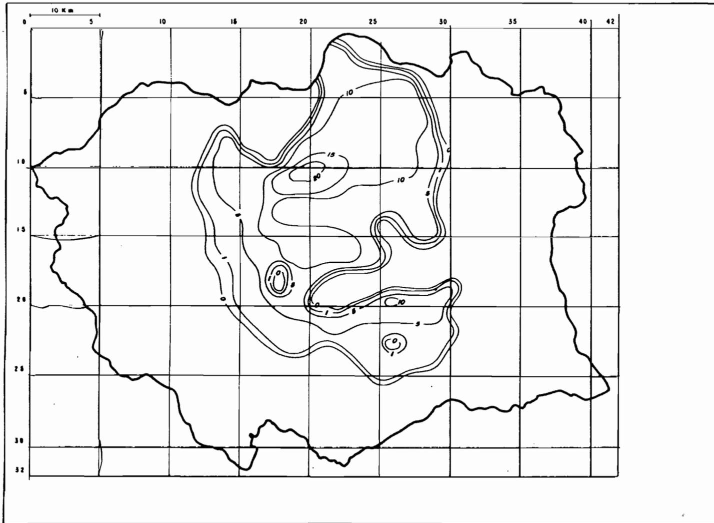
Fig. 14. Conductividad hidráulica vertical del acuitardo  $10^{-9}$  m/seg.
